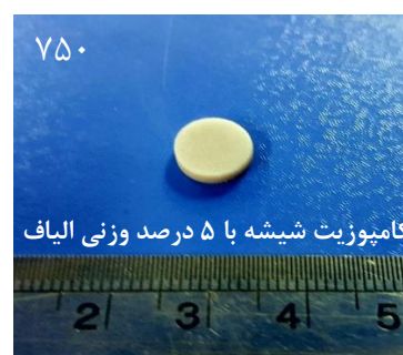
شکل ۳-۵: مقایسه تغییر شکل ظاهری ناشی از سینتر در دماهای ۷۵۰ و ۸۵۰ درجه سانتیگراد
