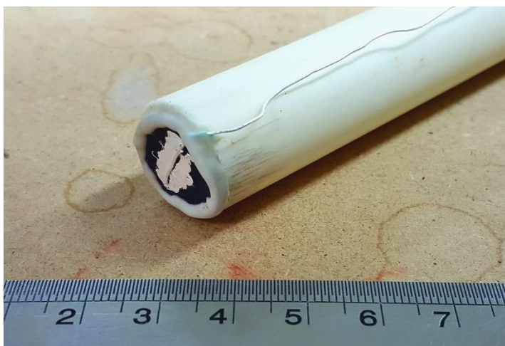
شکل ۲-۲۷: نحوه اتصال آب‌بند و تک‌سل پیل سوختی به لوله آلومینایی
