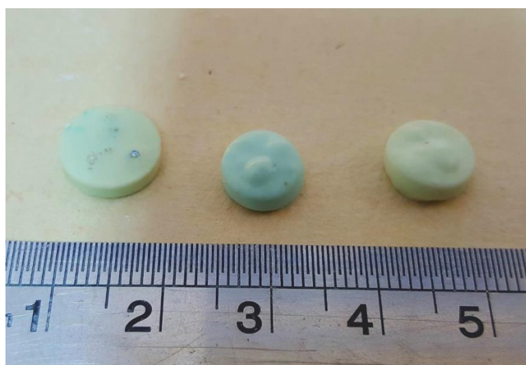
شکل ۳-۶: تاول‌های سطحی ایجاد شده در کامپوزیت‌های شامل میکا
