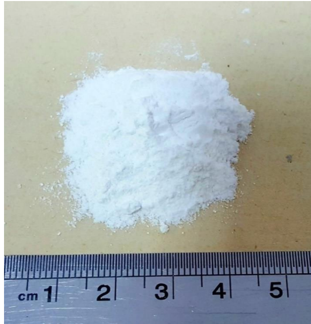
شکل ۲-۳: پودر شیشه به دست آمده پس از آسیا کاری
