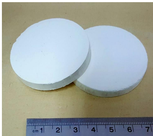
شکل ۹-۲: مواد اولیه فشرده سازی شده جهت ذوب
