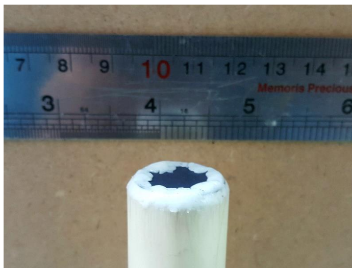
شکل ۲۵-۲: نحوه قرار گیری چسب آببند بر روی محل مورد نیاز به آببندی
