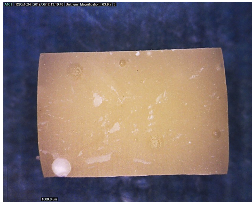
شکل ۴-۸: سطح شکست نمونه آزمون فشار سیمان پانویا خالص.
