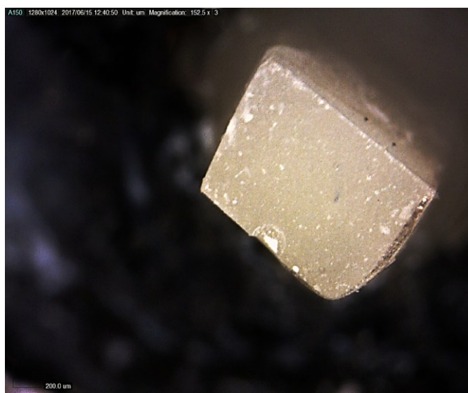
شکل ۴-۱۳: سطح شکست نمونه آزمون ریزکشی حاوی ۱ درصد وزنی پودر نانو هیدروکسی آپاتیت عملیات سطحی شده.
