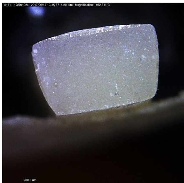
شکل ۴-۱۲: سطح شکست نمونه آزمون ریزکشی حاوی ۲ درصد وزنی پودر نانو هیدروکسی آپاتیت.
