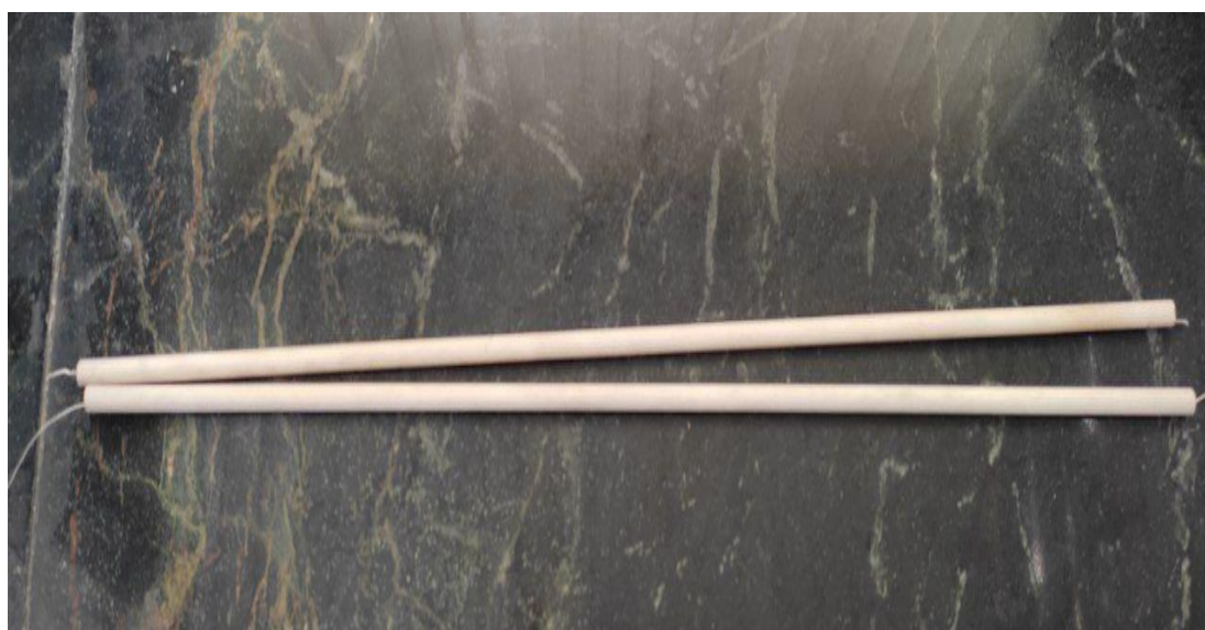
شکل ۲-۲۰: سیم های نیکلی در داخل بوتۀ آلومینایی برای اندازه گیری مقاومت در دمای بالا
