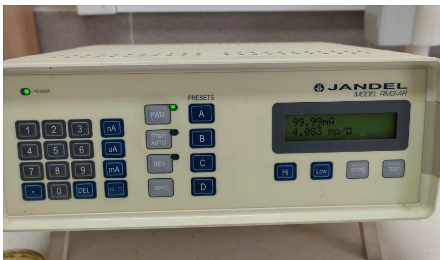
شکل ۳-۱۹: مقاومت سطحی اندازه‌گیری شده با دستگاه مقاومت سطحی.
