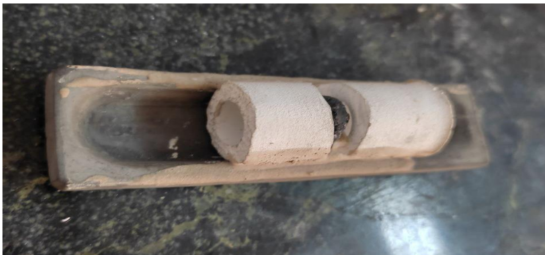
شکل ۲-۱۹: نمونه آماده شده اندازه گیری مقاومت در دمای بالا.
