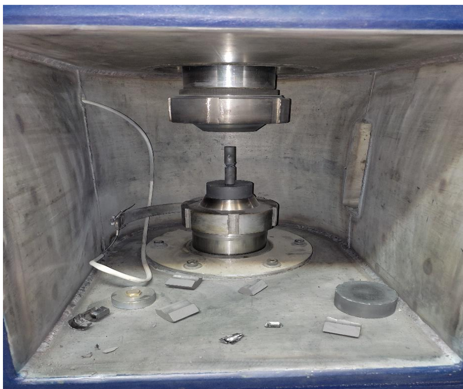
شکل ۳-۲۶: شکست نمونه و قالب در دمای ۷۷۰ درجه سانتی گراد.
