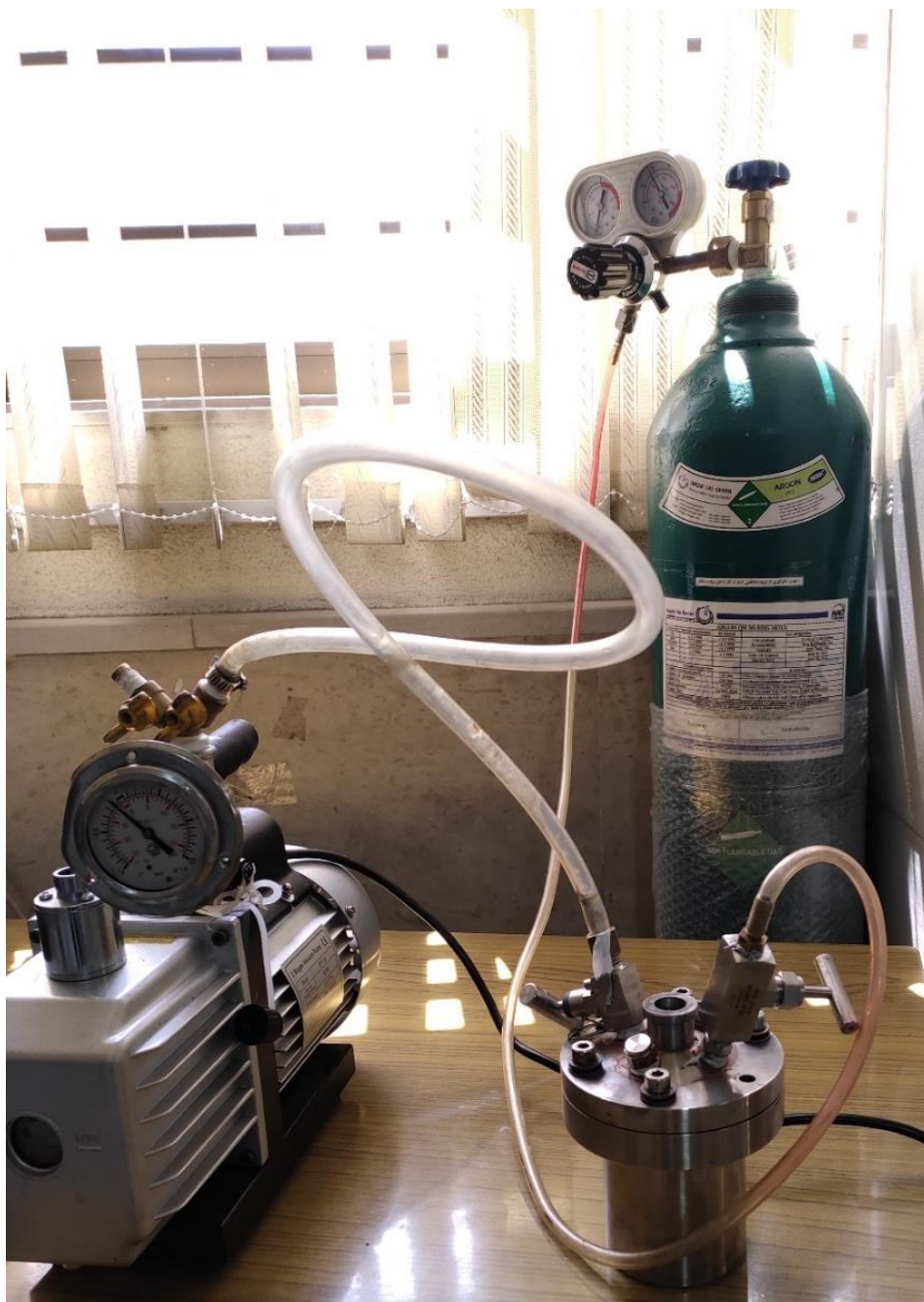
شکل ۲-۳: فرایند گاز دهی آرگون به داخل محفظه به همراه خلأ کردن محفظه.
