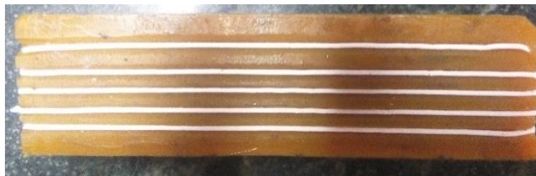
شکل ۱۱-۲ نحوه قرارگیری نمونه‌ها بر صفحه پلی‌اتیلنی شیاردار.
