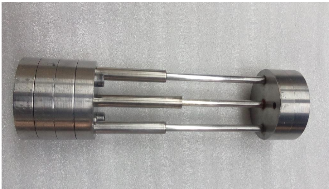
شکل ۹-۲ تصویر قالب سرهم شده.
