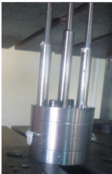
شکل ۳-۵ تصویر قالب در هنگام اکستروود کردن خمیر ۶.
