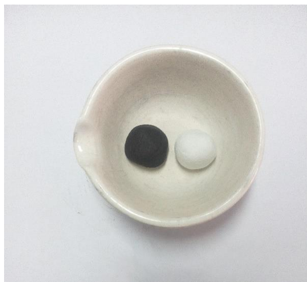
شکل ۵-۲ شکل ظاهری خمیر الکترولیت (خمیر سفید) و خمیر هسته (خمیر سیاه).
