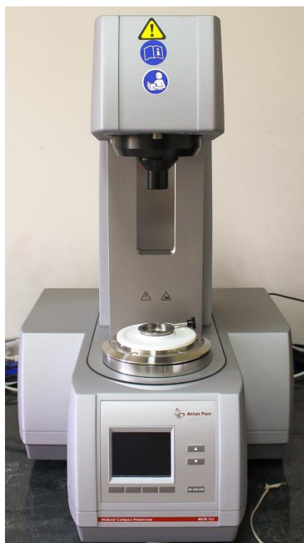
شکل ۶-۲ تصویر دستگاه رئومتر.
