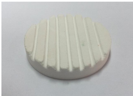
شکل ۱۲-۲ تصویر ظرف پخت شیاردار ساخته‌شده.
