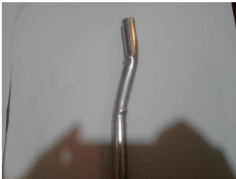
شکل ۴-۱۴- لوله آلومینیوم در اثر بارگذاری خستگی
