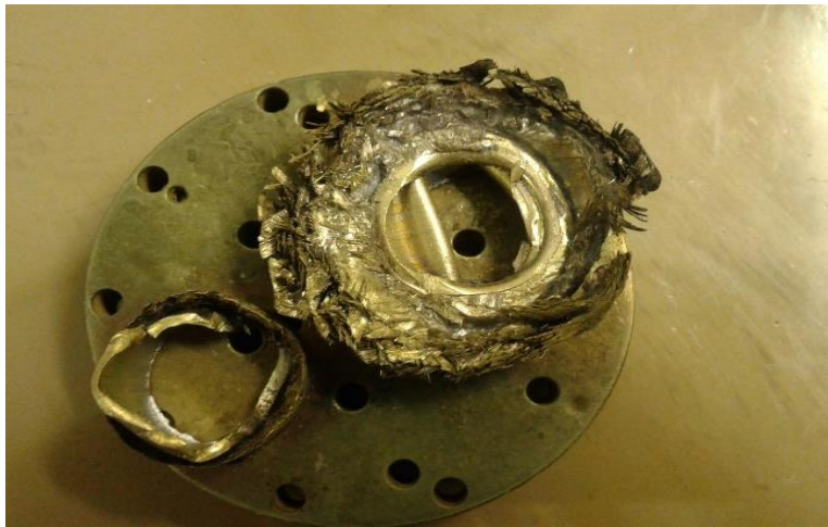
شکل ۲-۶- تصویر پوشش طلا داده شده بر روی مقطع شکست لوله‌ها در اثر بارگذاری فشاری و خستگی به منظور آنالیز SEM
