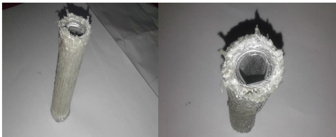
شکل ۴-۱۰- مکانیزم شکست لوله آلومینیوم تحت بارگذاری فشاری
