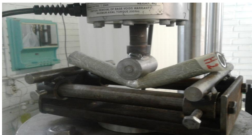
شکل ۲-۷- تصویر دستگاه آزمایش خمش سه نقطه ای لوله آلومینیوم-کامپوزیت
