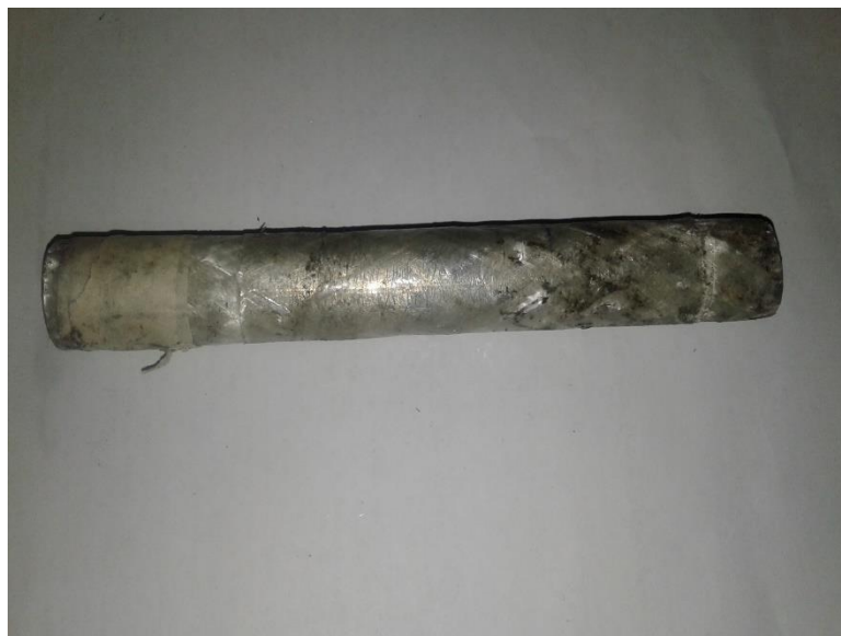
شکل ۴-۲۰- لوله آلومینیوم-کامپوزیت تک لایه شیشه در اثر بارگذاری خستگی
