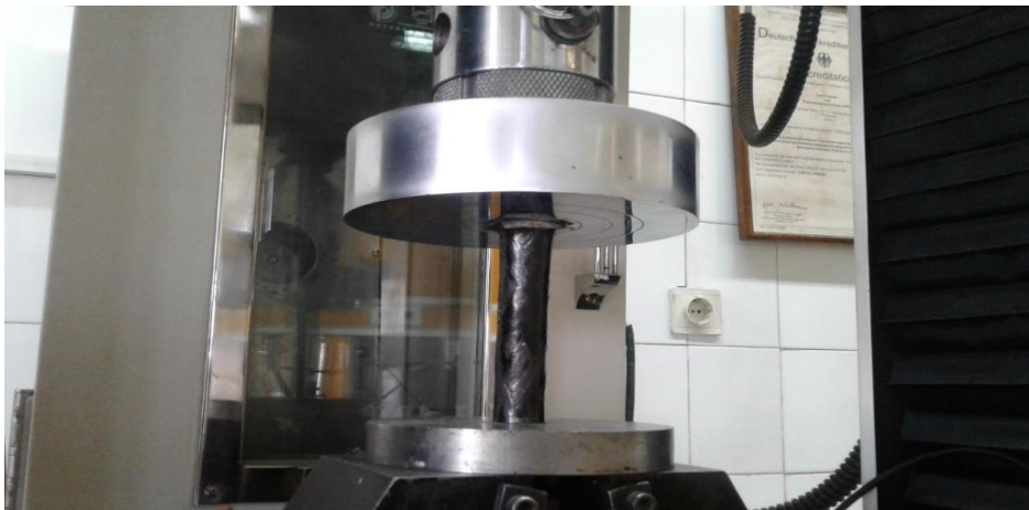
شکل ۲-۸- دستگاه آزمایش فشار محوری لوله آلومینیوم-کامپوزیت
