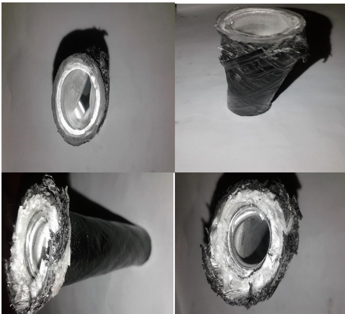
شکل ۴-۱۲- مکانیزم شکست لوله آلومینیوم-کامپوزیت هیبریدی الیاف شیشه و کربنی دولایه تحت بارگذاری فشاری
