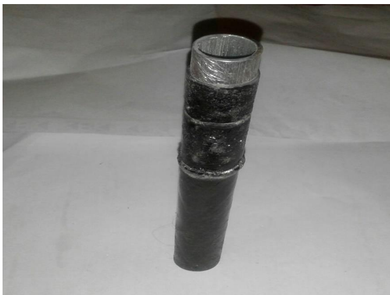
شکل ۴-۱۷- لوله آلومینیوم-کامپوزیت تک لایه کربنی در اثر بارگذاری خستگی
