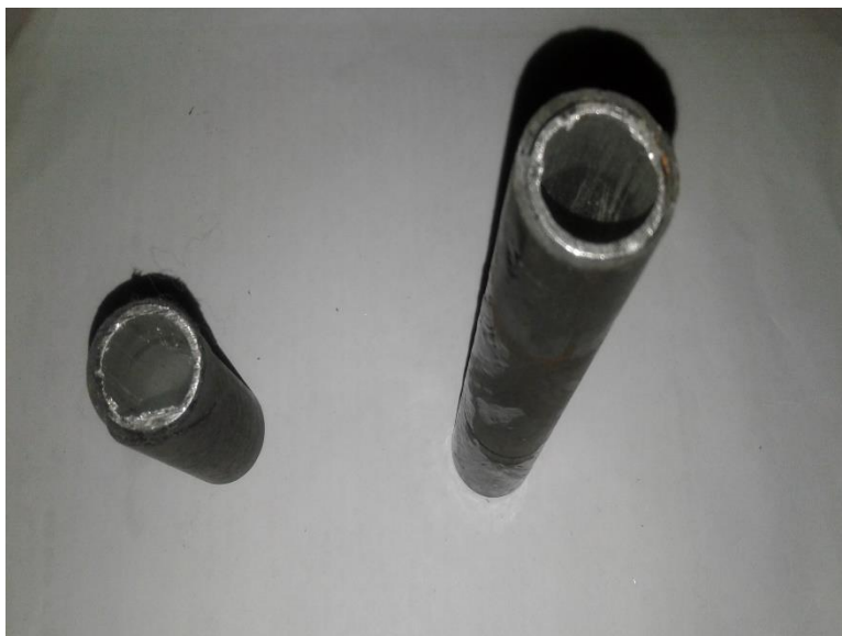
شکل ۴-۱۶- لوله آلومینیوم-کامپوزیت تک لایه کربنی در اثر بارگذاری خستگی
