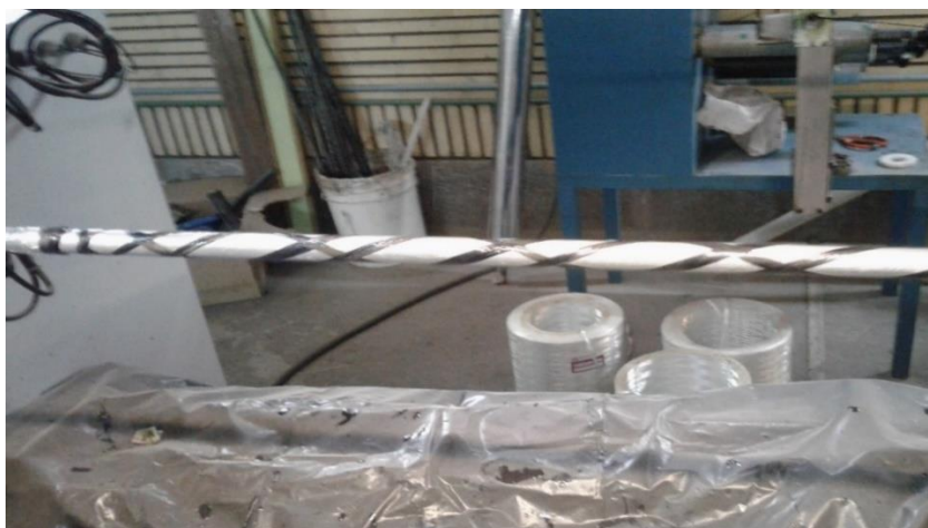
شکل ۲-۲- تصویر ساخت لوله آلومینیوم-کامپوزیت هیبریدی با الیاف شیشه و کربن به روش رشته پیچی
