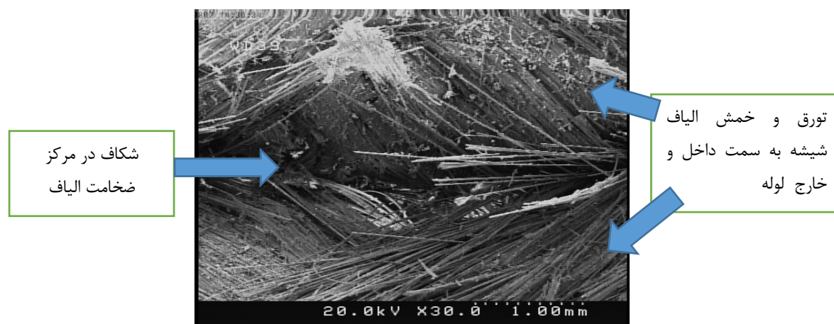
شکل ۲-۳- بررسی مقطع شکست مقطع نمونه لوله آلومینیوم-کامپوزیت الیاف شیشه دولایه تحت بارگذاری فشاری
