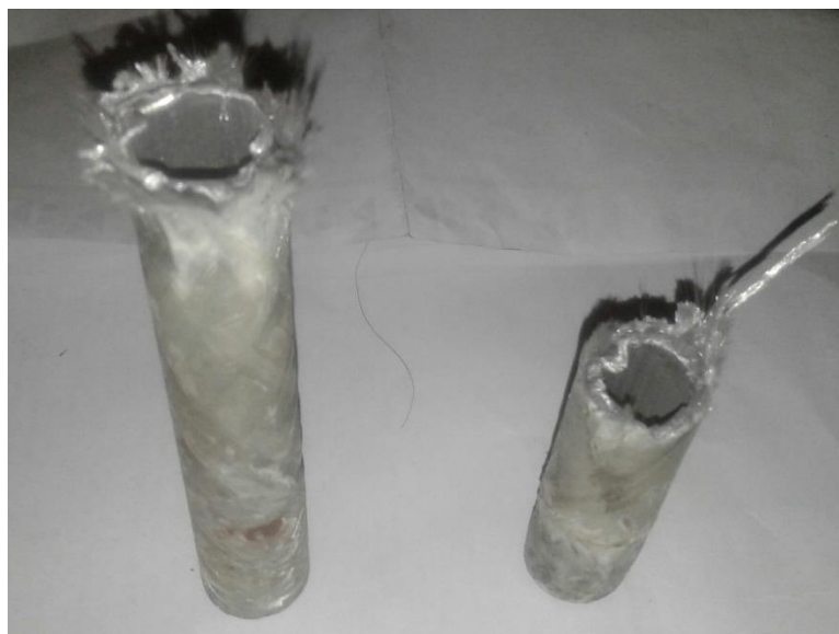
شکل ۴-۱۸- لوله آلومینیوم-کامپوزیت تک لایه شیشه در اثر بارگذاری خستگی
