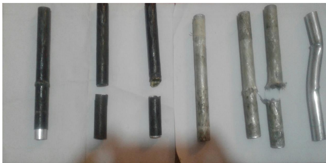
شکل ۴-۱۳- تصویر لوله های آلومینیوم، آلومینیوم-کامپوزیت تک لایه کربنی و شیشه ای در اثر بارگذاری خستگی خمشی
