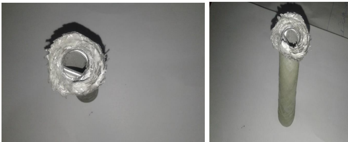
شکل ۴-۹- مکانیزم شکست لوله آلومینیوم-کامپوزیت الیاف شیشه دولایه تحت بارگذاری فشاری
