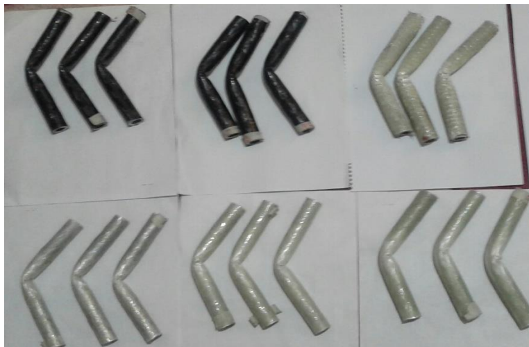
شکل ۴-۱- تصویر لوله‌های آلومینیوم-کامپوزیت تحت بارگذاری خمشی
