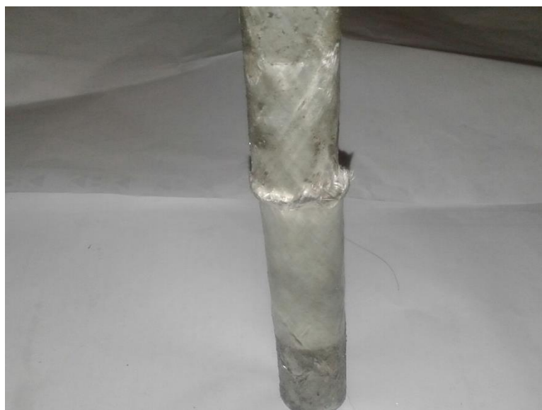
شکل ۴-۱۹- لوله آلومینیوم-کامپوزیت تک لایه شیشه در اثر بارگذاری خستگی
