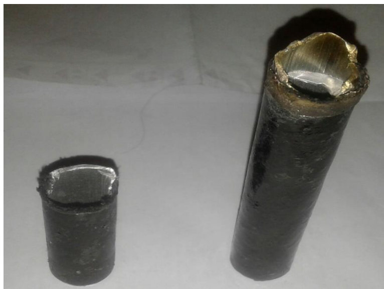
شکل ۴-۱۵- لوله آلومینیوم-کامپوزیت تک لایه کربنی در اثر بارگذاری خستگی
