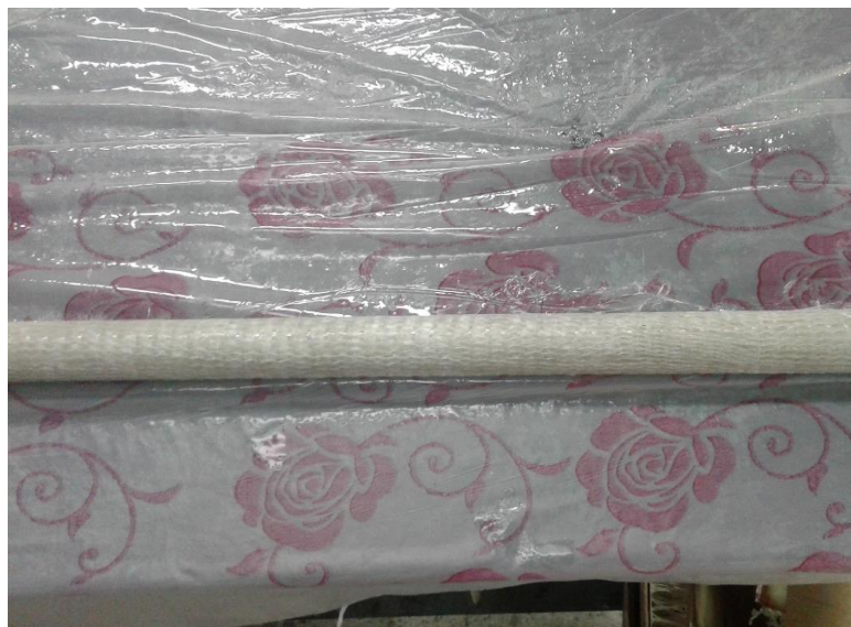
شکل ۲-۳- تصویر ساخت لوله آلومینیوم-کامپوزیت با پارچه شیشه به روش دستی
