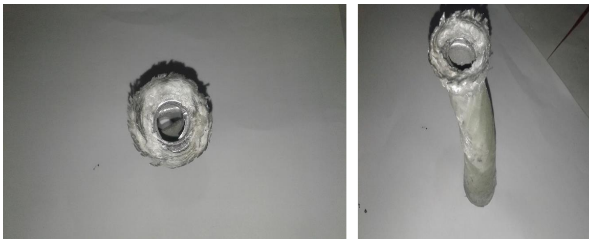
شکل ۴-۸- مکانیزم شکست لوله آلومینیوم-کامپوزیت الیاف شیشه سه لایه تحت بارگذاری فشاری
