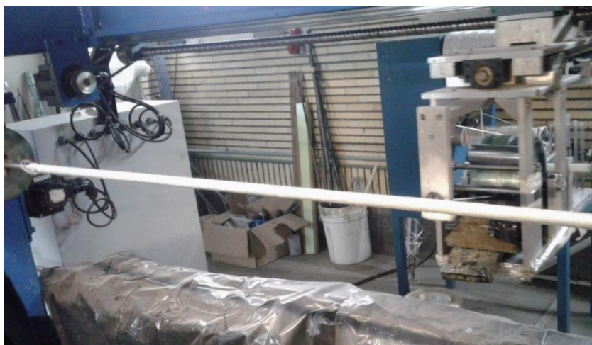
شکل ۲-۱- تصویر ساخت لوله آلومینیوم-کامپوزیت با الیاف شیشه به روش رشته پیچی
