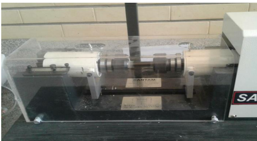
شکل ۲-۹- دستگاه آزمایش خستگی لوله آلومینیوم-کامپوزیت
