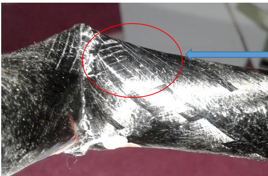
شکل ۴-۶- مکانیزم شکست خمشی لوله های آلومینیوم- کامپوزیت با الیاف کربنی تک لایه
