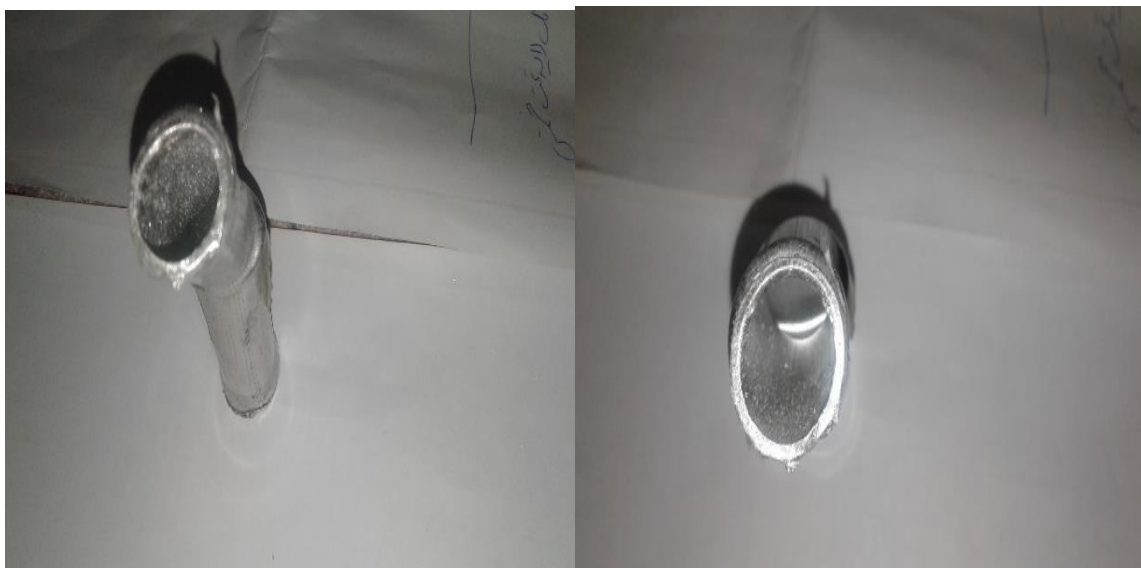
شکل ۴-۱۰- مکانیزم شکست لوله آلومینیوم تحت بارگذاری فشاری
