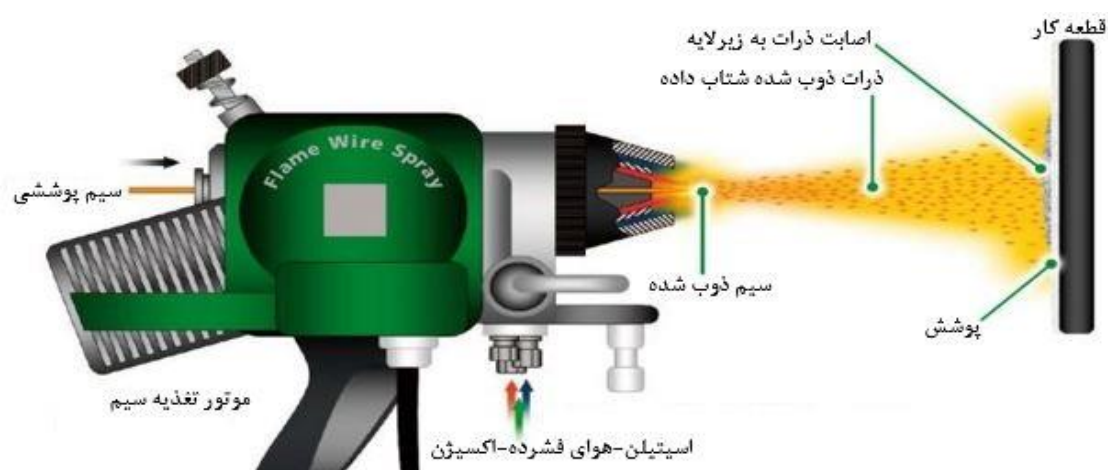
شکل ۱۳-۱ شماتیک تفنگ Flame Wire Spray [۵۲].
