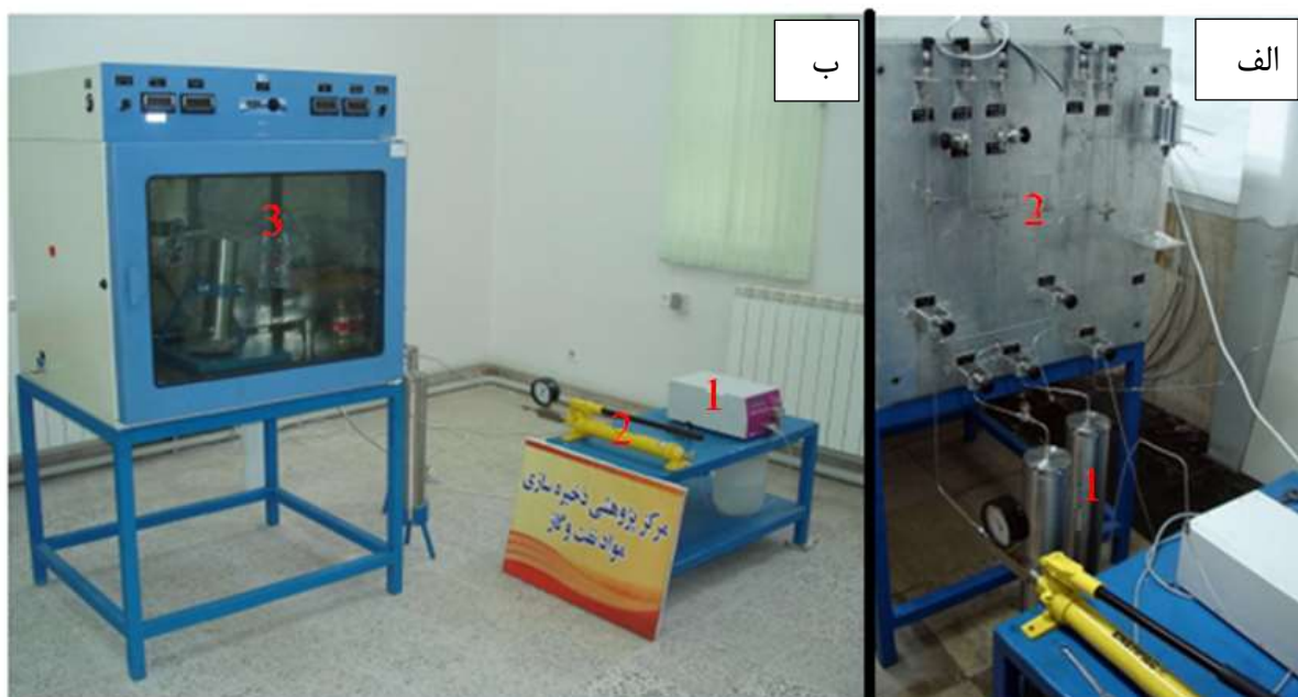
شکل (۳-۶): الف) نمای پشت دستگاه، ۱) محفظه پمپ سیال ۲) لوله‌های انتقال سیال پشت دستگاه - ب) نمای کلی دستگاه ۱) پمپ تزریق ۲) پمپ روغن فشار محصورکننده (HPLC) ۳) آون و مغزه نگهدارنده.
