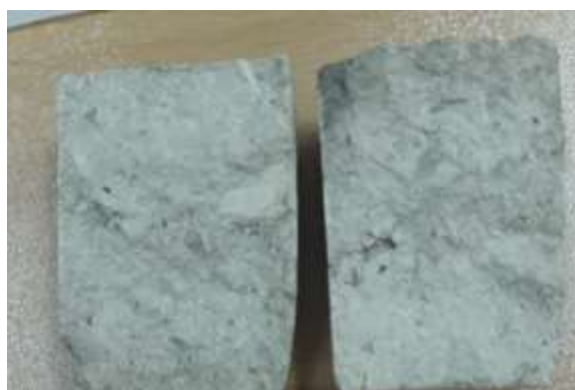
شکل (۱۰-۳) صفحه شکستگی نمونه S2-1.
