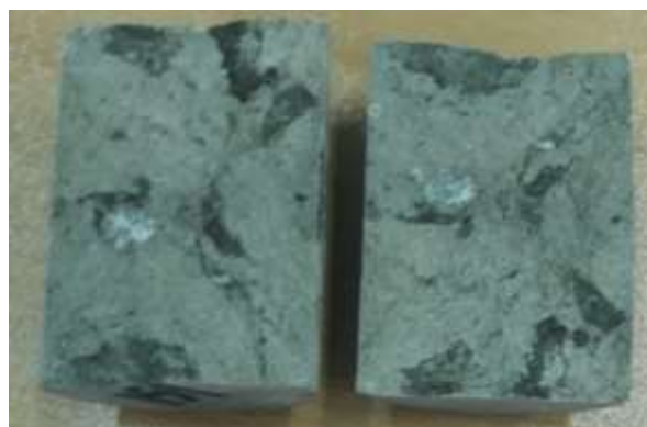
شکل (۱۲-۳) صفحه شکستگی نمونه S2-3.
