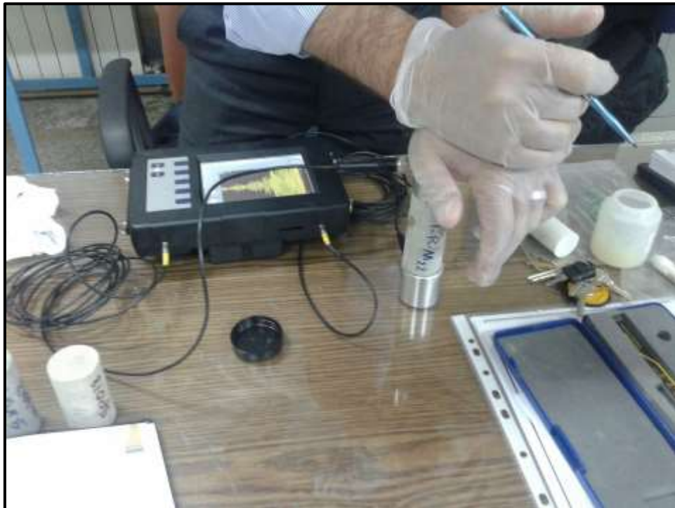
شکل (۳-۵) تصویر نحوه انجام آزمایش اولتراسونیک.
