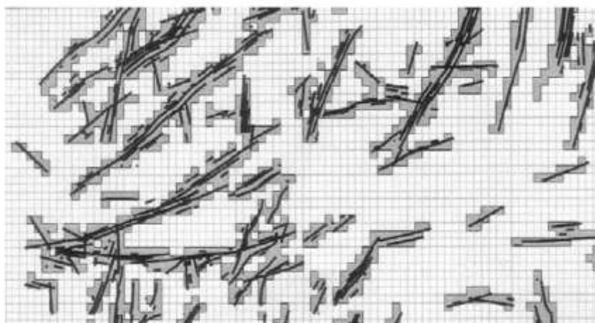
شکل (۲-۱۸) مدل سازی درزه در مدل پیوسته (Fung, et al., 2005).
