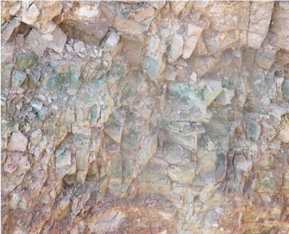
شکل ۲-۱۴: نمایی از ماده معدنی (مالاکیت و کالکوسیت) در زون A که در واحد شیلی واقع شده است.
