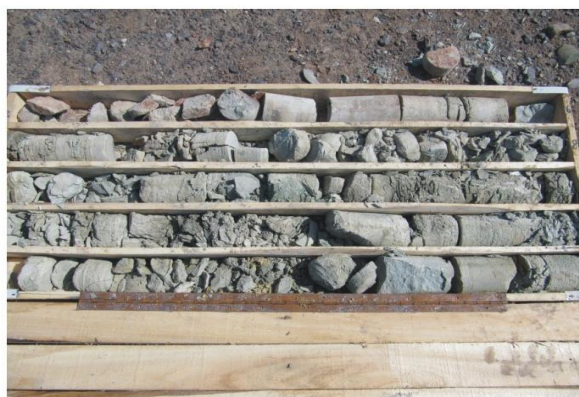
شکل ۴-۲: مقطع عرضی گمانه ۱ و مغزه‌های حفاری آن که حاوی رگچه‌های بسیار ظریف کالکوسیت و مالاکیت است.
