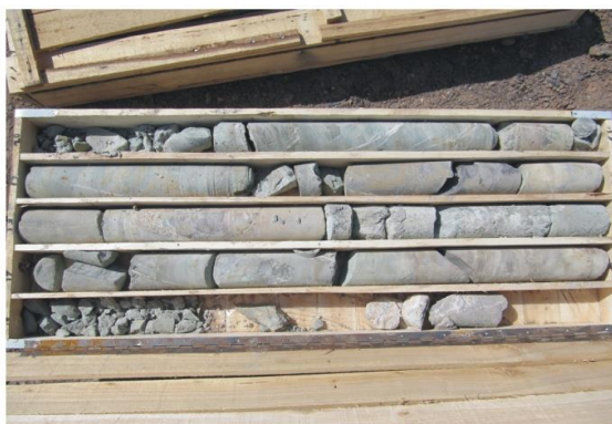
شکل ۴-۵: مقطع عرضی گمانه ۴ و مغزه‌های حفاری آن که حاوی رگچه‌های بسیار ظریف کالکوسیت و مالاکیت است.
