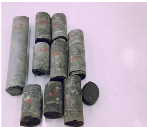
شکل ۴-۶- مغزه گیری از نمونه‌های برداشته شده از کارگاه معدن جهت انجام آزمایش بار نقطه‌ای
