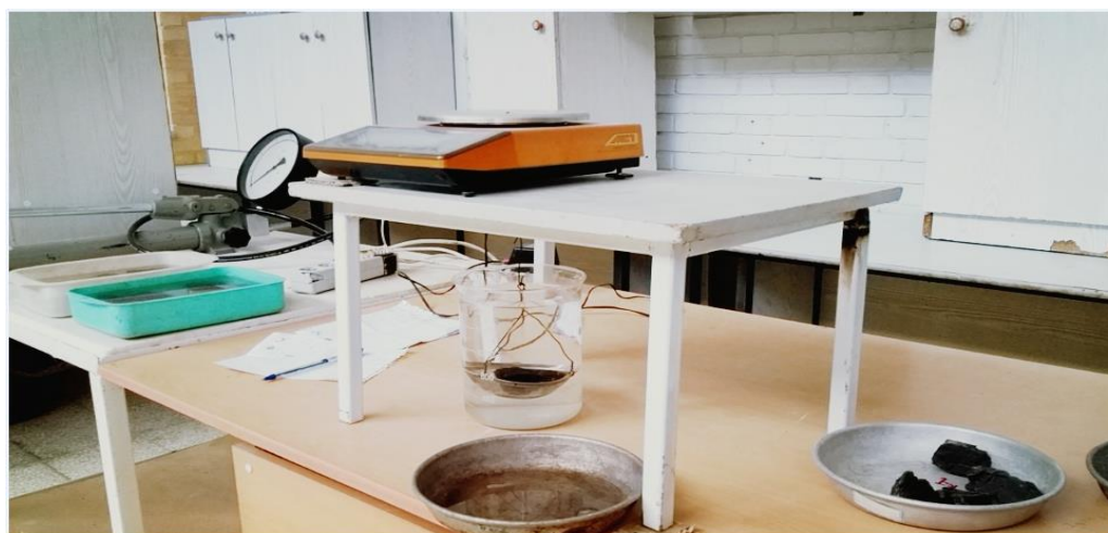
شکل ۴-۵- تعیین چگالی کمر بالا و کمر پائین به روش اشباع و غوطه‌وری
