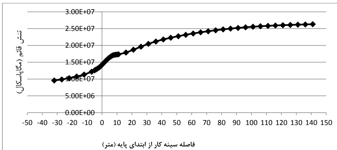
شکل ۴-۴۲- نمودار متوسط تنش قائم وارد بر پایه باتوجه به فاصله سینه کار
