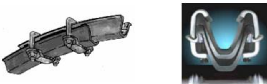
شکل ۲-۵- نمائی از مقطع قاب کشویی آرک
