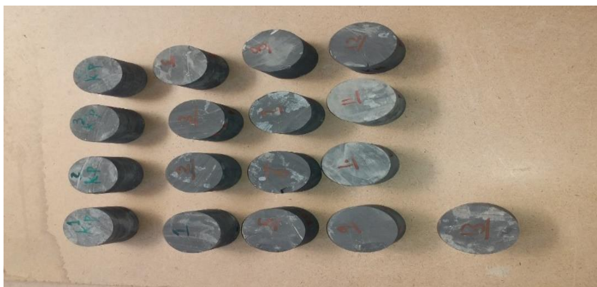
شکل ۴-۷- استانداردسازی ابعاد نمونه‌ها به طول ۴ سانتی‌متر جهت بارگذاری
