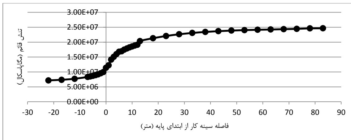
شکل ۷۲-۴- نمودار متوسط تنش قائم وارد بر پایه سه‌متری فوقانی باتوجه‌به فاصله سینه کار
