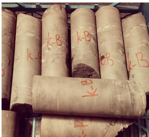
شکل ۴-۶- مغزه گیری از نمونه‌های برداشته شده از کارگاه معدن جهت انجام آزمایش بار نقطه‌ای
