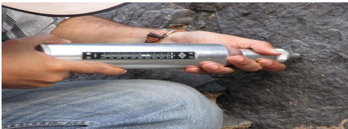
شکل ۳-۱۴ سنجش مقاومت فشاری دیواره‌ی درزه جناح چپ با استفاده از چکش اشمیت
