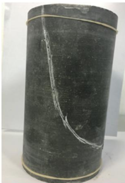
شکل ۲-۲۳ الگوی شکست حاصل از (الف) مدلسازی عددی با الگوریتم دکسترا و (ب) آزمون آزمایشگاهی [۶۰]
