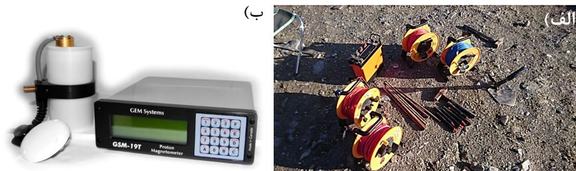
شکل ۴-۶- تجهیزات مورد استفاده در برداشت ژئوالکتریک و ب) دستگاه مغناطیس‌سنج و VLF مدل GSM-19T
