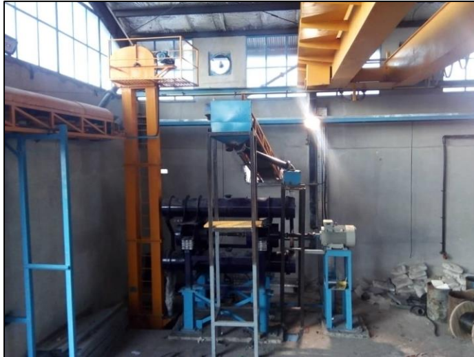
شکل ۳-۲: آسیای ارتعاشی مورد استفاده در معدن.
