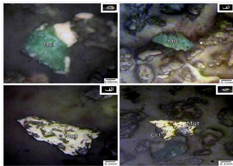
شکل ۴-۸: الف) نمایی از بلور مالاکیت آزاد؛ ب) بلور مالاکیت درگیر با کانی غیرفلزی؛ ج) نمایی از کانی‌های مگنتیت و کالکوپیریت به صورت درگیری ساده با یکدیگر؛ د) نمایی از بلور مگنتیت آزاد.
