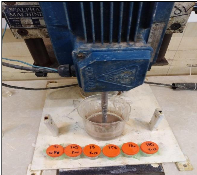
شکل ۴-۱۸: نمایی از انجام آزمایش سینتیکی لیچینگ.
