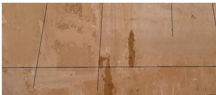
شکل ۵-۱: (الف) خط برداشت برای ناپیوستگی‌های موجود (ب) استفاده از کمپاس برای برداشت ناپیوستگی
