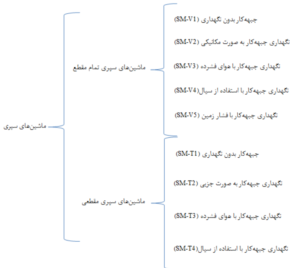
شکل ۷-۴: تقسیم‌بندی ماشین‌های حفر تونل بر اساس نوع سپر و مکانیزم نگهداری جبهه‌کار [38]
