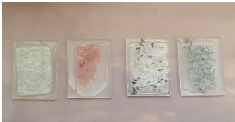
شکل ۷-۴ مقاطع نازک تهیه شده از نمونه‌های سنگی برای تعیین ضریب بافت
