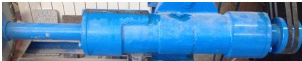
شکل ۴-۹ گلویی دستگاه برش برای بستن دیسک الماس و انتقال نیرو
