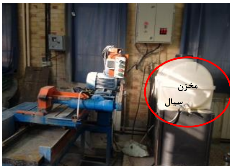
شکل ۴-۸ مخزن سیال تهیه شده برای فرآیند برش
