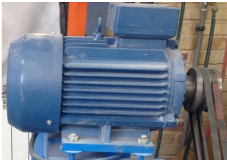
شکل ۴-۱۰ موتور اصلی دستگاه برش سنگ
