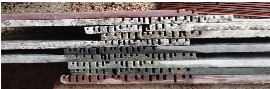
شکل ۴-۱۵ نمونه پلاک‌های برش خورده تحت شرایط عملیاتی مختلف
