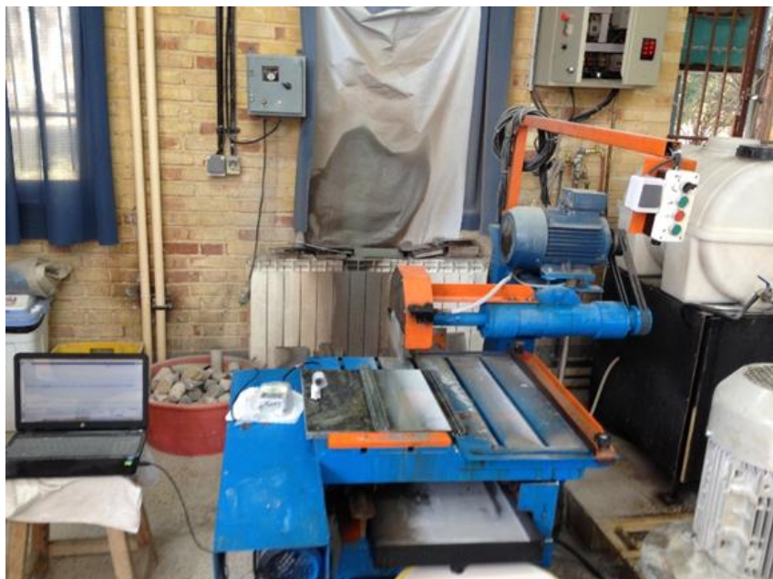
شکل ۴-۱۲ نمایی از دستگاه برش دهنده دیسکی در مقیاس آزمایشگاهی
