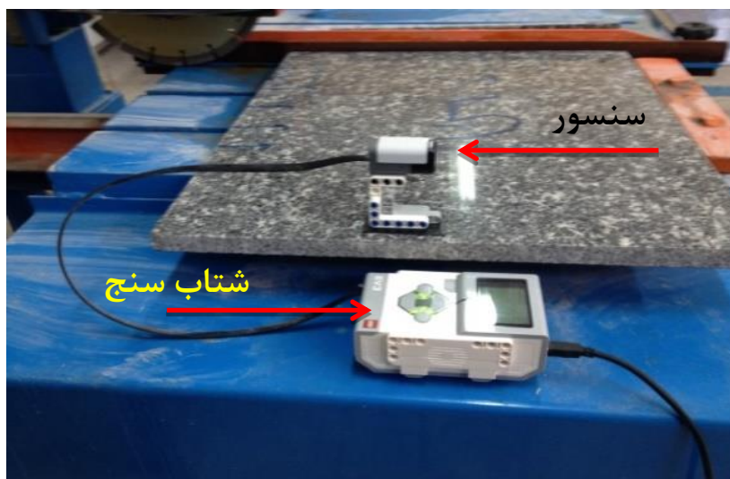
شکل ۴-۱۳ شتاب سنچ و سنسور ارتعاش برای ثبت ارتعاشات سیستم
