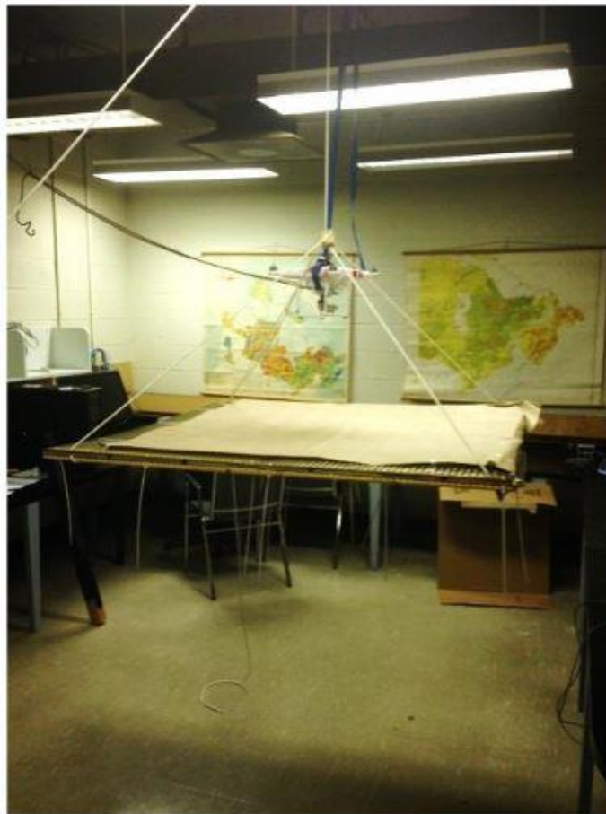
شکل ۴-۴. اجزاء سیستم برداشت پهباد آزمایشگاهی جهت بررسی اثرات مغناطیسی استاتیکی و دینامیکی (Parvar et al., 2016).
