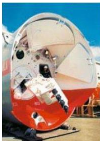
شکل ۴-۵: ماشین حفاری مکانیزه با سپر هوای فشرده (Maidl et al., 2013)
