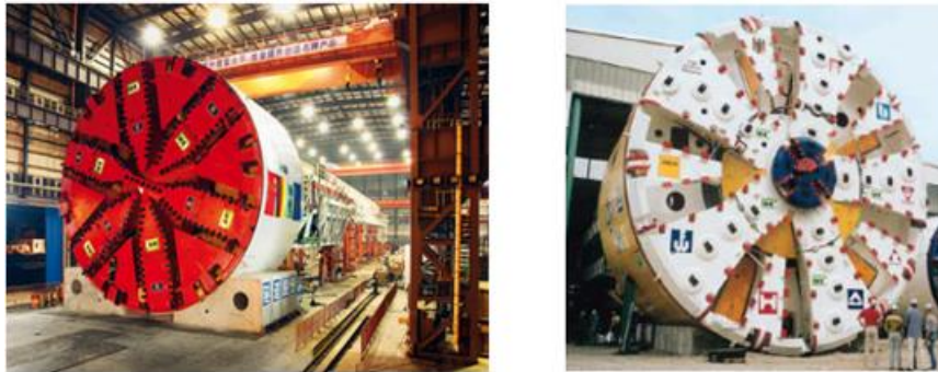
شکل ۴-۱۱: ماشین‌های ترکیبی با قطر ۱۴/۲ و ۱۵/۶ متر (Maidl et al., 2013)
