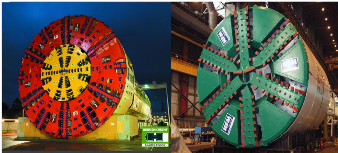
شکل ۴-۲: (تصویر راست مربوط به EPB TBM برای متروی شهر شیراز با قطر ۶/۸۸ متر (آجورلو، ۱۳۹۴) و تصویر سمت چپ مربوط به Slurry TBM برای خط متروی شهر مادرید با قطر ۱۵/۱ متر (Maidl et al., 2014))
