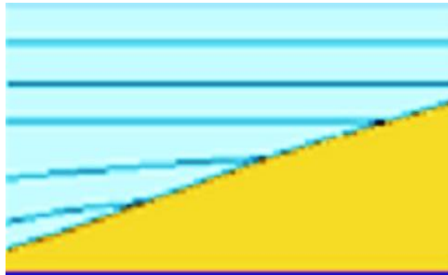
شکل ۳-۳: نمایی از ختم شدگی روهم پوشان در یک مقطع لرزه‌ای [۳۲]
