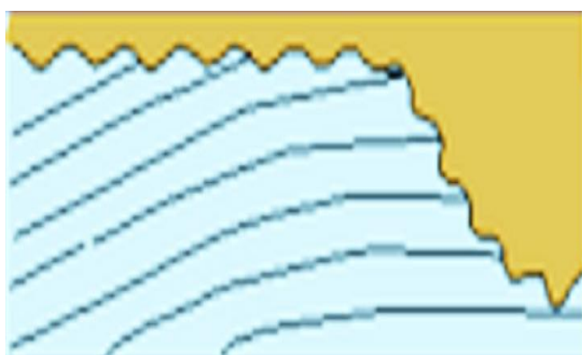
شکل ۳-۵: تصویری از ختم شدگی فرسایشی یک مقطع لرزه‌ای [۳۰]، بدون مقیاس
