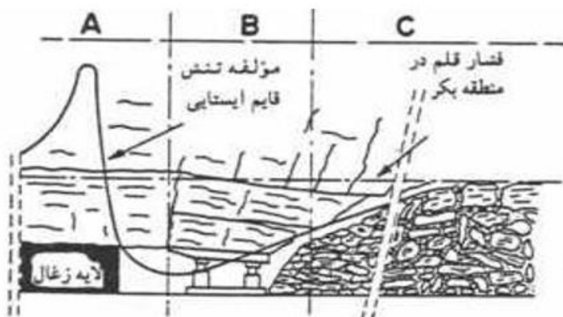
شکل ۲-۲- توزیع تنش در سقف پهنه استخراج جبهه کار طولانی (Bieniawski, 1987).
