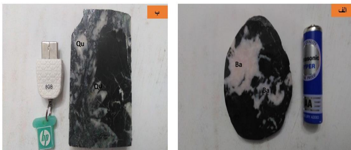
شکل ۳-۱: کوارتز و باریت در مقاطع صیقلی (الف) باریت پراکنده در سطح مقطع (رنگ سفید مایل به صورتی) (ب) کوارتز در تمام سطح مقطع به رنگ سفید قابل مشاهده است.
