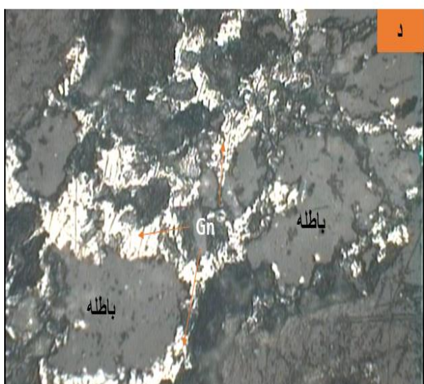
شکل ۳-۱۹: تصویر ذرات بین ۲۵۰ و ۴۰۰ میکرون (الف) رگه‌ی بزرگ اسفالریت که با دانه‌های ریز پیریت و باطله قفل شده (بزرگنمایی ۲۰x) در نور ppl (ب) بالا سمت راست: ذرات آزاد اسفالریت، مرکز: اسفالریت درگیر با باطله (بزرگنمایی ۲۰x) در نور ppl (ج) گالن به شکل آزاد (بزرگنمایی ۲۰x) در نور ppl (د) گالن‌های قفل شده در حاشیه باطله (بزرگنمایی ۲۰x) در نور ppl.
