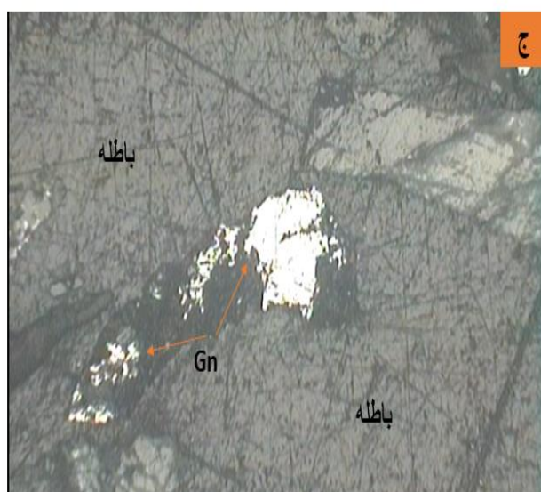
شکل ۳-۱۹: تصویر ذرات بین ۲۵۰ و ۴۰۰ میکرون (الف) رگه‌ی بزرگ اسفالریت که با دانه‌های ریز پیریت و باطله قفل شده (بزرگنمایی ۲۰x) در نور ppl (ب) بالا سمت راست: ذرات آزاد اسفالریت، مرکز: اسفالریت درگیر با باطله (بزرگنمایی ۲۰x) در نور ppl (ج) گالن به شکل آزاد (بزرگنمایی ۲۰x) در نور ppl (د) گالن‌های قفل شده در حاشیه باطله (بزرگنمایی ۲۰x) در نور ppl.
