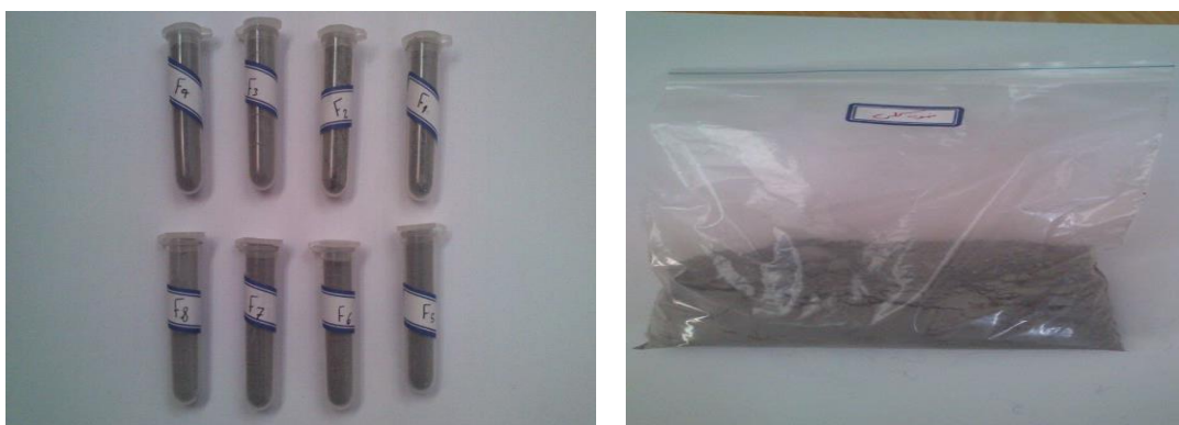
شکل ۲-۲: نمونه‌های آماده شده جهت آنالیز XRD
