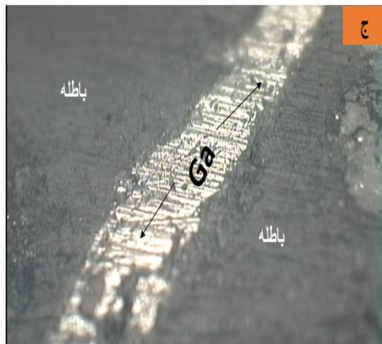
شکل ۳-۲۳۳: تصاویر ذرات بین ۵۹۵ و ۸۴۱ میکرون الف) اسفالریت قفل شده با باطله و پیریت (بزرگنمایی ۲۰x در نور ppl ب) اسفالریت آزاد (بزرگنمایی ۱۰x) در نور ppl ج) رگه آزاد گالن (بزرگنمایی ۱۰x) در نور ppl د) دانه‌های ریز گالن قفل شده در حاشیه اسفالریت (بزرگنمایی ۲۰x) در نور ppl
