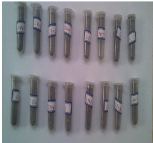
شکل ۲-۳: نمونه‌های آماده شده جهت آنالیز جذب اتمی و آسیای دستی از جنس آگات
