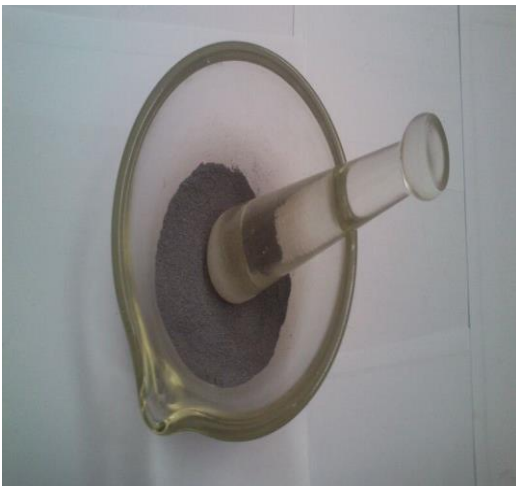
شکل ۲-۳: نمونه‌های آماده شده جهت آنالیز جذب اتمی و آسیای دستی از جنس آگات
