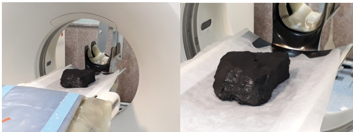
شکل ۵-۴- نمونه زغال در حال سی تی اسکن
