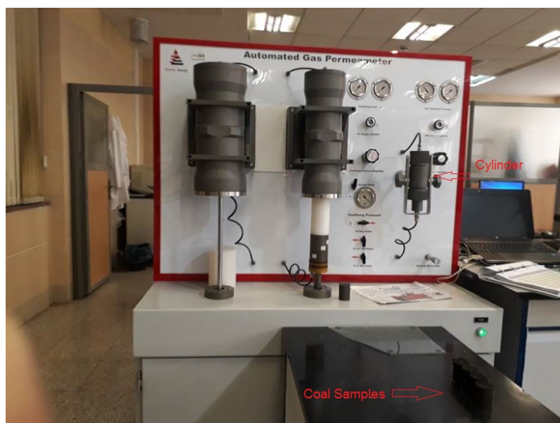
شکل ۴-۲۷- دستگاه تعیین نرخ نفوذپذیری AGP، آزمایشگاه مهندسی مخزن پژوهشکده مهندسی نفت پژوهشگاه صنعت نفت
