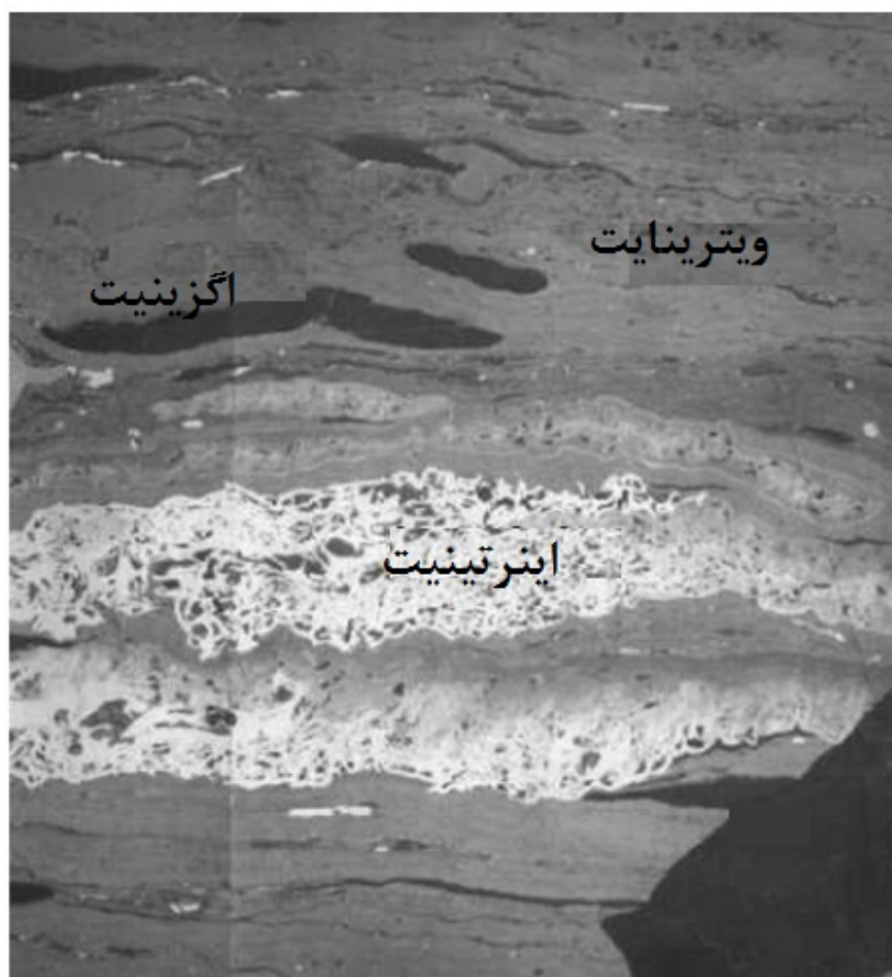
شکل ۴-۲۱- نمایش میکروسکوپی ماسرال‌های ویتترینایت و فیوزینیت و اینرتینیت (Schweinfurth, 2002)
