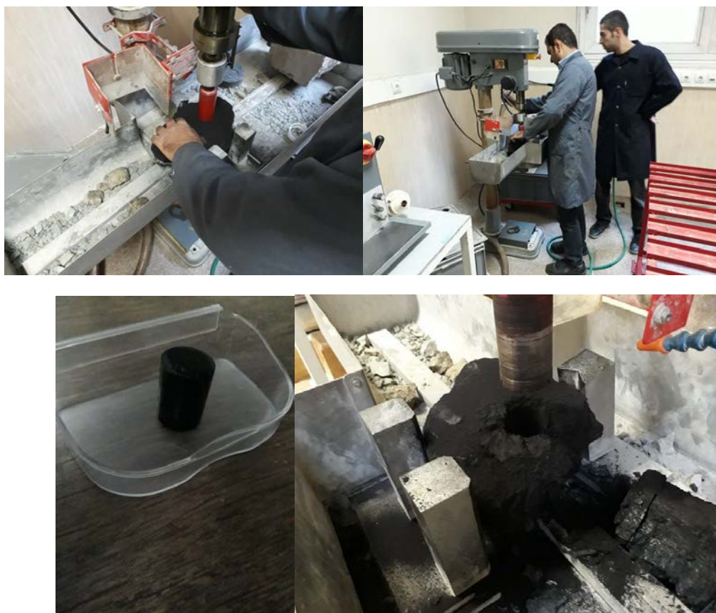
شکل ۴-۲۶- مراحل تهیه مغزه از نمونه های زغال، انیستیتو نفت پردیس دانشکده های فنی دانشگاه تهران
