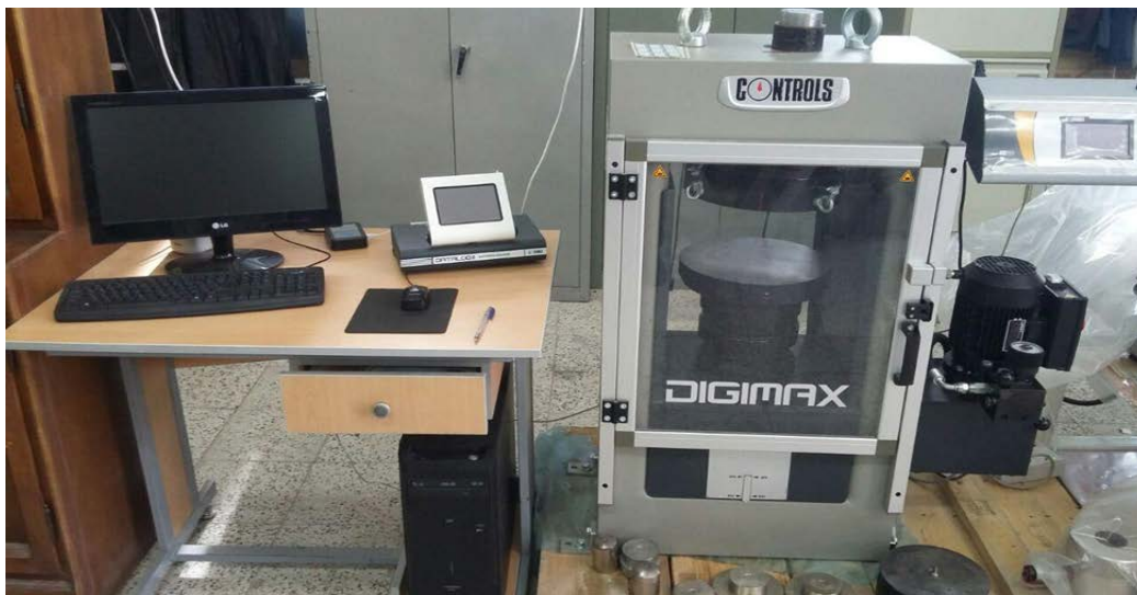
شکل ۴-۲: دستگاه بارگذاری نیمه خودکار Digimax compact line
