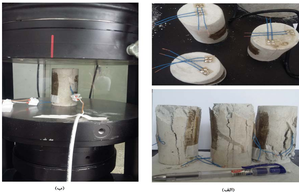
شکل ۴-۵: (الف) نمونه قبل و بعد از بارگذاری، (ب) نمونه در زیر دستگاه بارگذاری
