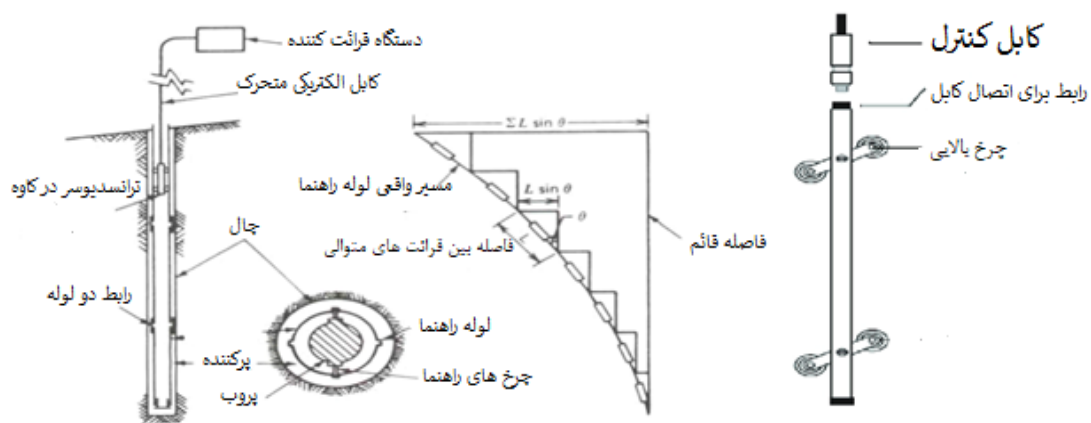
شکل ۲-۱: طرح کلی انحراف سنج و عملکرد آن (Dunncliff, 1993).
