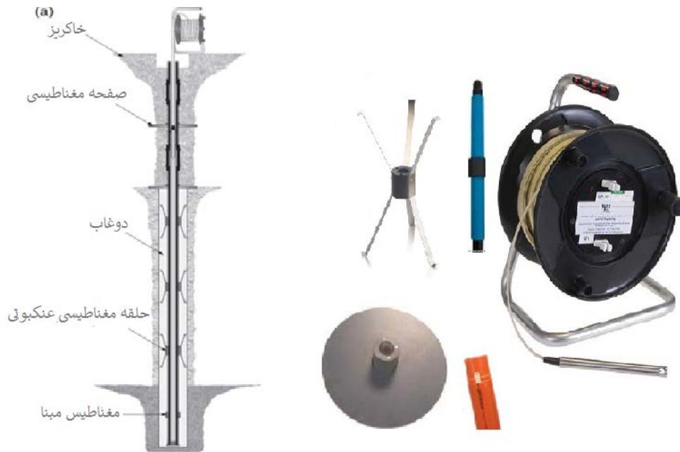
شکل ۲-۲: حلقه مغناطیسی عنکبوتی و صفحه‌ای و پروب اندازه‌گیری (Slope Indicator Company, 2017).
