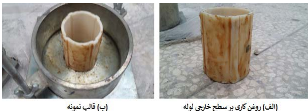
شکل ۴-۱۶: الف) روغن کاری بر سطح خارجی کل لوله، ب) قالب مورد استفاده
