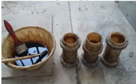
ج) قالب های آماده و روغن کاری شده
