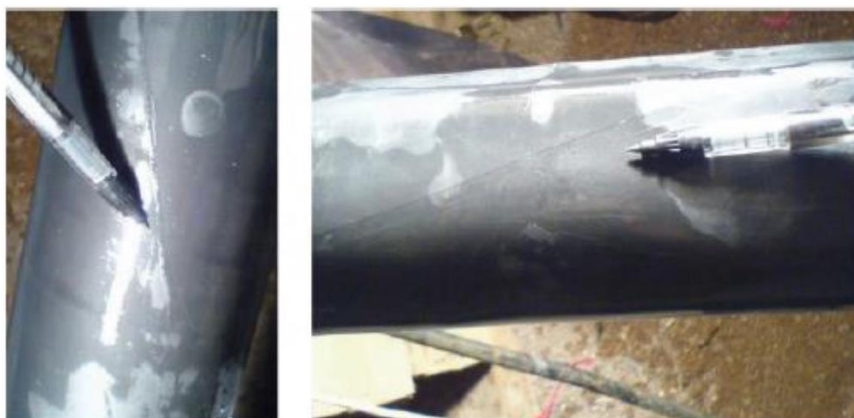
شکل ۲-۴- اثر ترک مربوط به شکست هیدرولیکی بر روی پوشش لاستیکی Impression packer (Ziaie Moayed et al., 2012)
