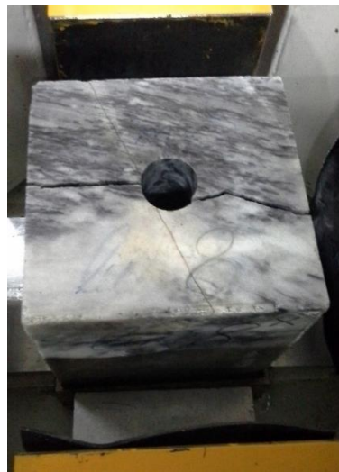
شکل ۶-۳۱- شکستگی ایجاد شده در نمونه شماره ۸
