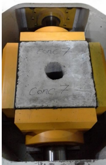
شکل ۶-۳۴- تثبیت نمونه به کمک جک‌های جانبی
