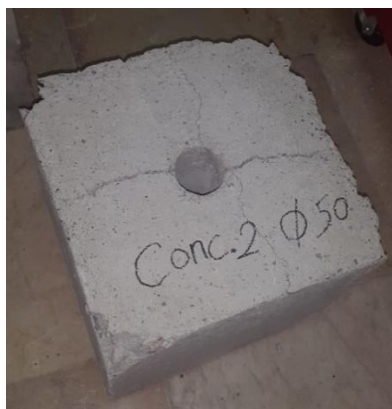
شکل ۶-۱۶- ترک‌ها و شکستگی‌های کششی ایجاد شده در نمونه ۲ به علت سطح ناصاف آن
