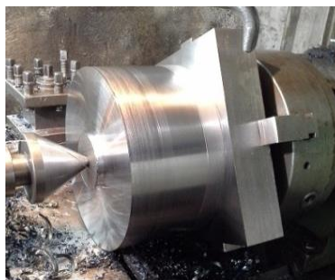
شکل ۵-۱۵- جک‌ها در مرحله تراش
