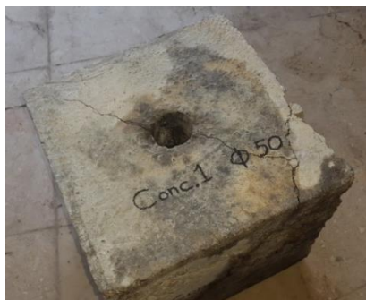
شکل ۶-۱۲- شکستگی ایجاد شده در نمونه
