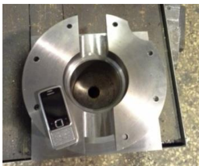
شکل ۵-۱۸- نمای داخلی سامانه تزریق
