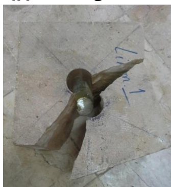
شکل ۶-۲۹- نمونه شکسته شده در اثر تزریق سیال
