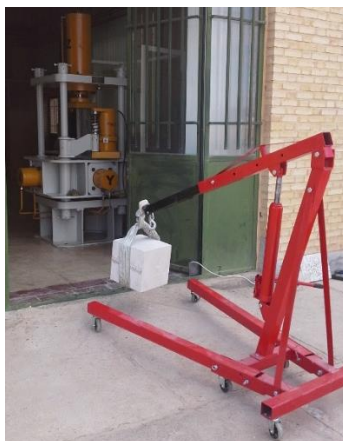
شکل ۶-۵- جرثقیل بکارگرفته شده برای حمل و نقل نمونه ها
