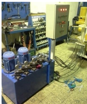
شکل ۵-۲۴- واحد هیدرولیک و اتصال آن به دستگاه سه محوره واقعی
