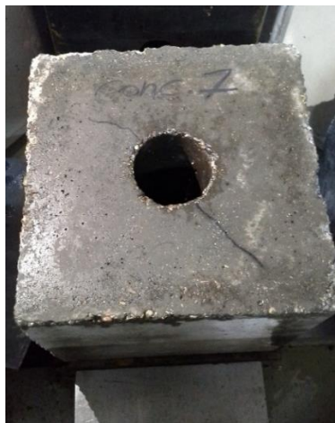
شکل ۶-۳۶- راستای شکستگی ایجاد شده در نمونه بتنی
