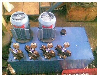
شکل ۵-۲۱- واحد هیدرولیک طی فرایند ساخت
