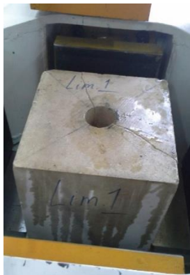
شکل ۶-۲۸- شکستگی ایجاد شده بر روی نمونه
