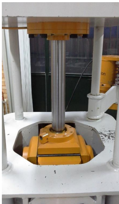
شکل ۶-۳۳- جانمایی نمونه در مرکز محفظه با استفاده از جک‌های قائم و جانبی
