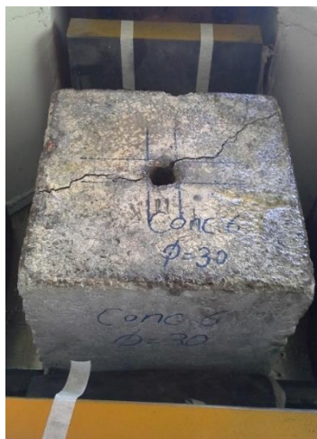
شکل ۶-۲۰- شکستگی ایجاد شده در نمونه شماره ۶ به علت سطح ناصاف آن
