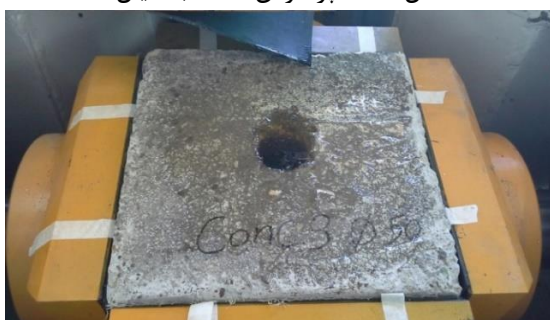
شکل ۶-۱۰- ریختن روغن به داخل سوراخ
