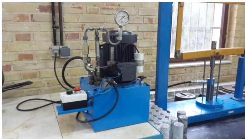
شکل ۴-۲- تصویری از دستگاه طراحی شده برای تزریق سیال در داخل سنگ
