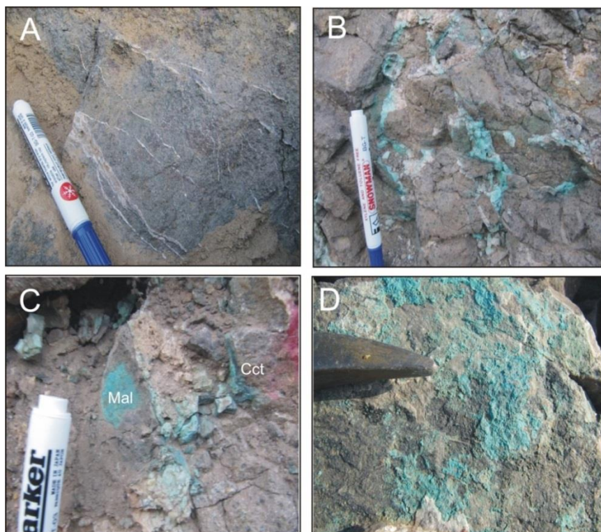
شکل (۳-۸): تصاویر ماکروسکوپی از ماده معدنی؛ (A) رگچه‌های کلسیتی درون سنگ میزبان پیروکسن آندزیت؛ (B) رگچه‌های مالاکیت و کلسیت درون سنگ میزبان آندزیت؛ (C) رگچه‌های کلسیتی و کالکوسیتی در میکروکنگلومرا؛ (D) سطح شکستگی پر شده با مالاکیت و آزوریت (کالکوسیت: Cct، مالاکیت: Mal). حروف اختصاری نشانگر کانی‌ها، از [Whitney and Evans, 2010].
