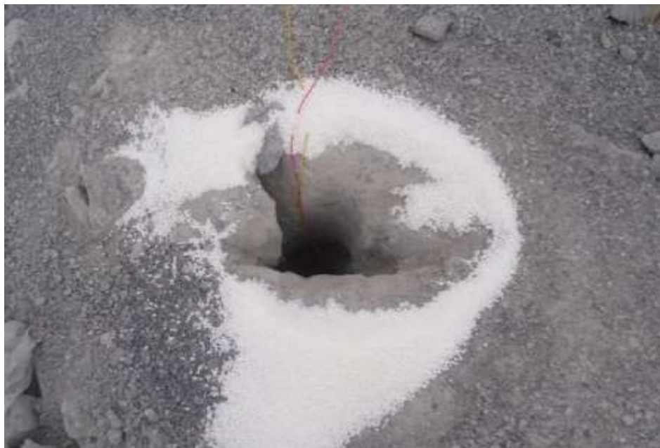
شکل (۴-۲) چال خرج‌گذاری شده در معدن سنگ آهک سیستان
