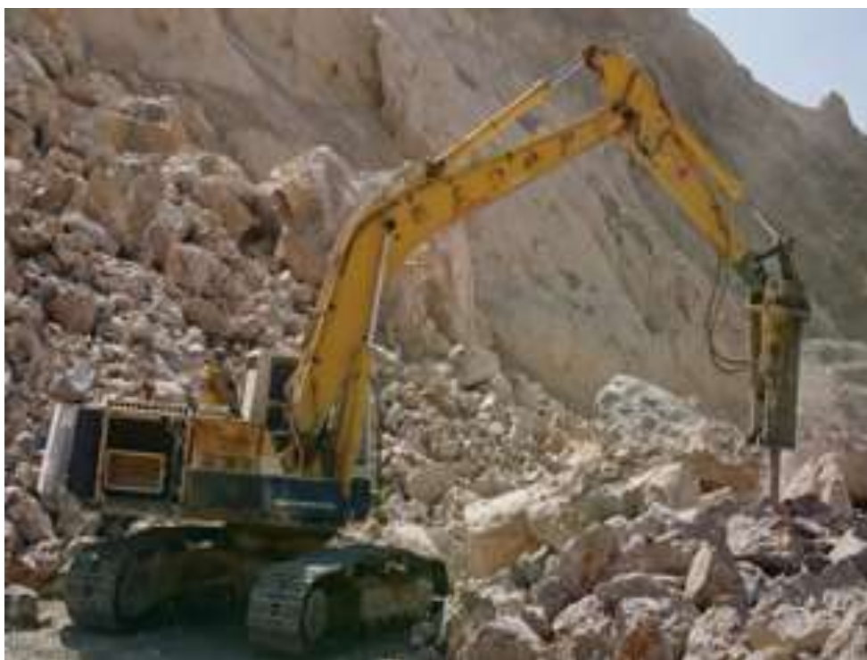
شکل (۶-۲) به کارگیری چکش هیدرولیکی در معدن سنگ آهک سیستان
