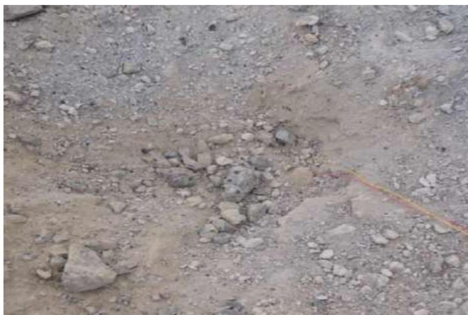
شکل (۵-۲) چال آماده آتش‌کاری در معدن سنگ آهک سیستان
