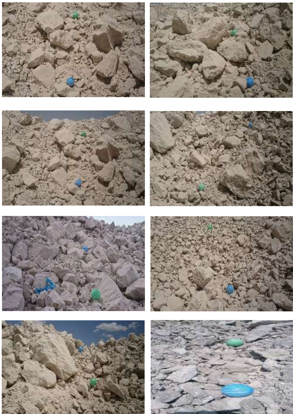
شکل (۱۱-۳) آنالیز تصاویر برداشت شده از توده آتش کاری شده انفجار چهارم توسط نرم افزار GOLD SIZE
