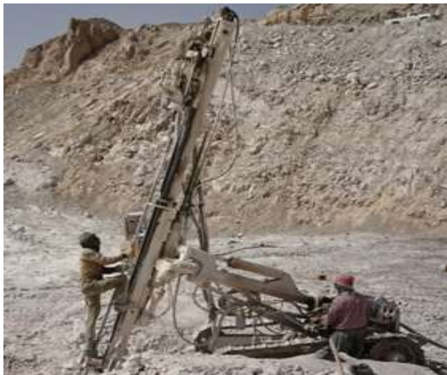
شکل (۲-۳) دریل واگن اینگرسولرند در معدن سنگ آهک سیستان
