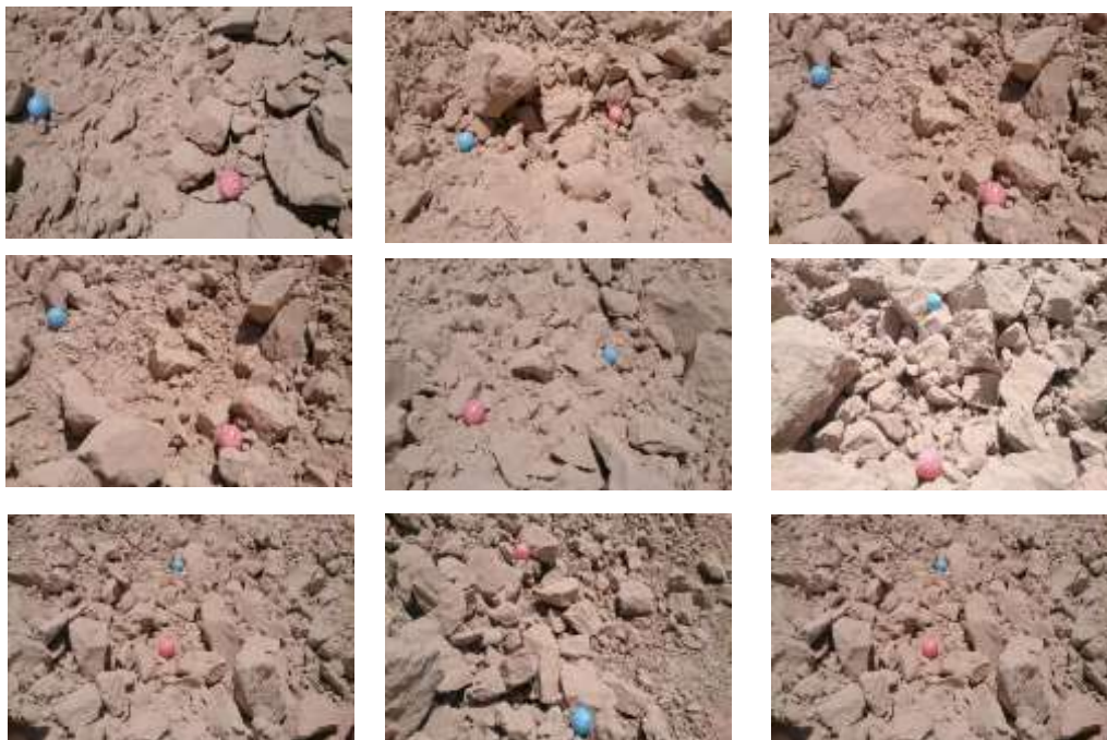
شکل (۵-۷) تصاویر برداشت شده از کپه آتش کاری شده الگوی پیشنهادی سوم
