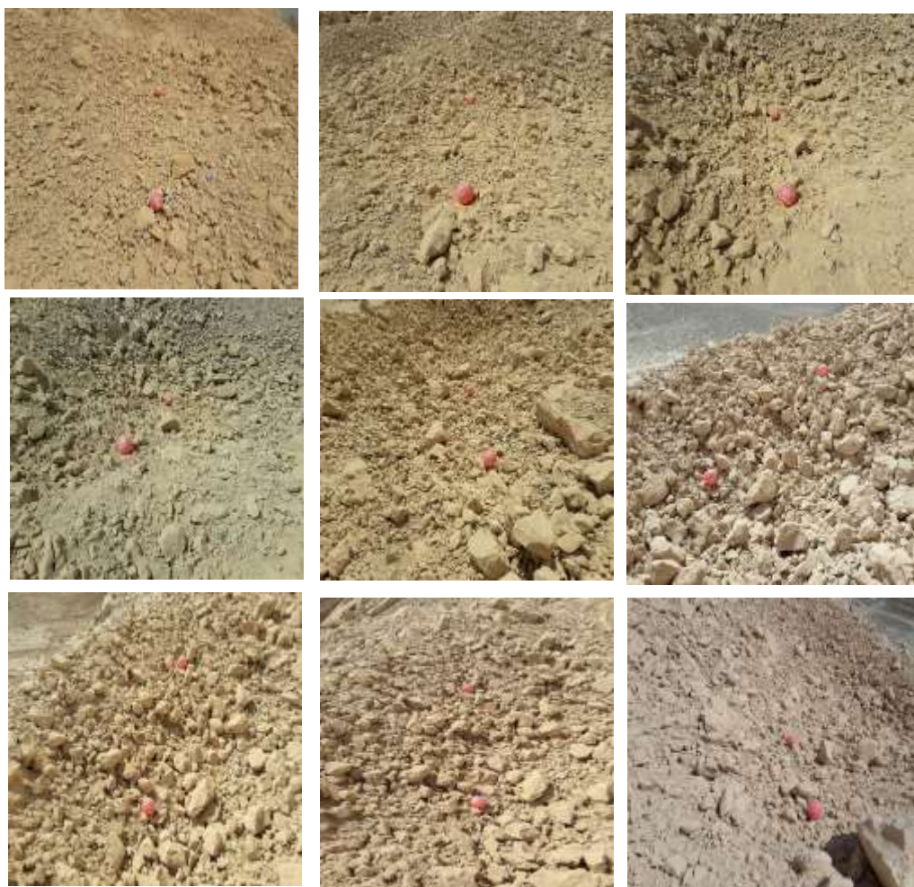
شکل (۵-۱) تصاویر برداشت شده از کپه آتش‌کاری شده الگوی پیشنهادی اول
