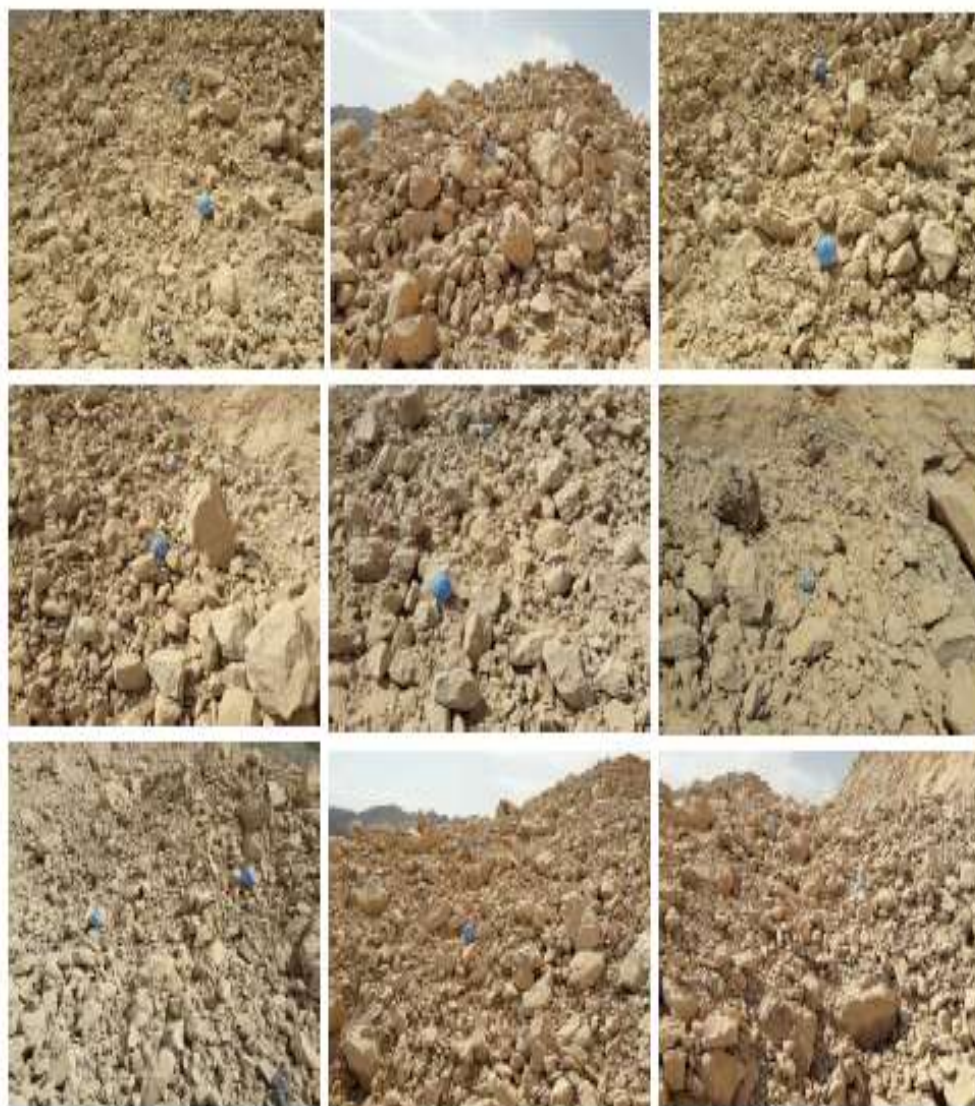
شکل (۴-۵) تصاویر برداشت شده از کپه آتش کاری شده الگوی پیشنهادی دوم
