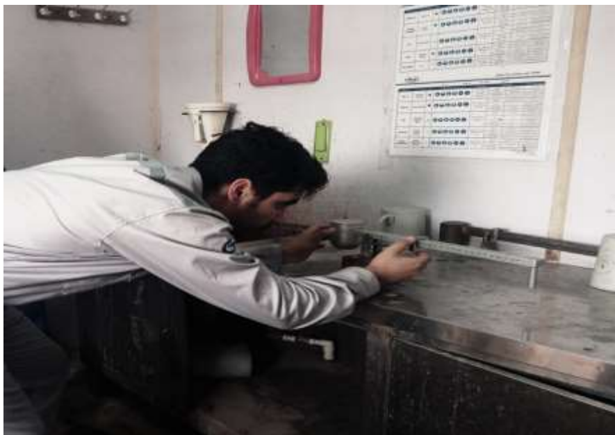
شکل پ-۱: وزن‌گیری گل حفاری با ترازوی مخصوص
