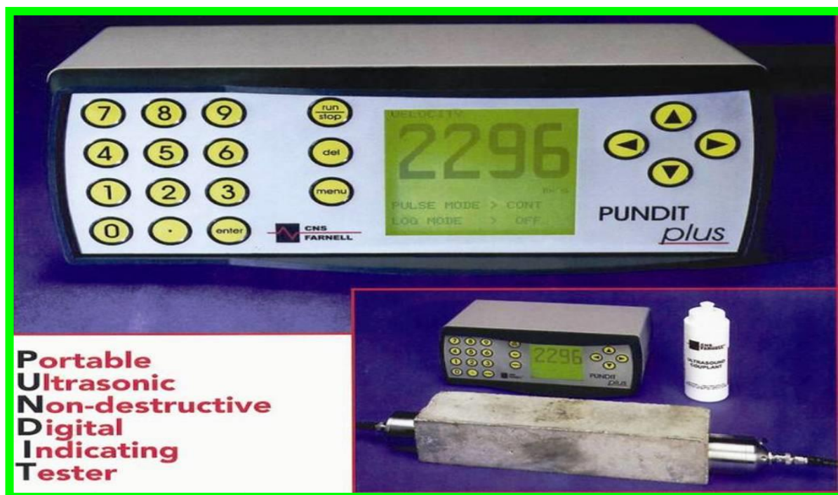
شکل ۴-۱۸ دستگاه تعیین مشخصات ترک شامل عرض، عمق، و مسیر آن تعیین محل حفره ها در داخل بتن تعیین ضریب پواسون مدول الاستیسیته
