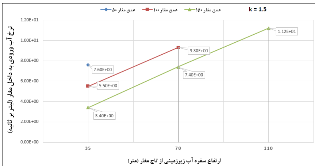
شکل ۶-۱۸- تغییرات نرخ آب ورودی به مغار در نسبت تنش افقی به قائم K = 1.5 (بدون سیستم پرده آب)
