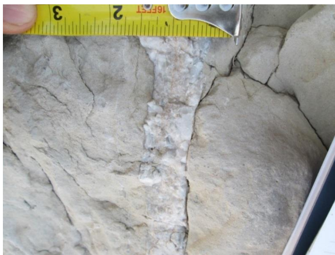
شکل ۴-۴- اندازه‌گیری بازشدگی و پرشدگی یکی از درزه‌های برداشت شده از رخنمون سطحی
