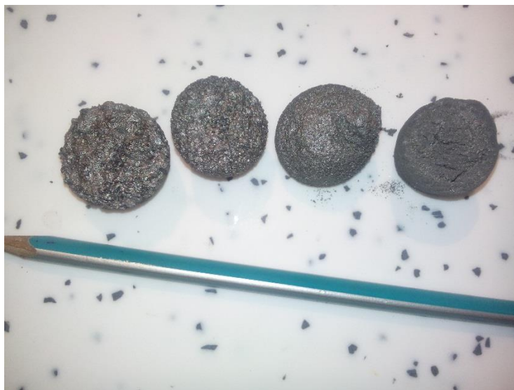
شکل ۴-۱۸: نمونه‌ی مواد فرار خوراک بعد از خروج از کوره
