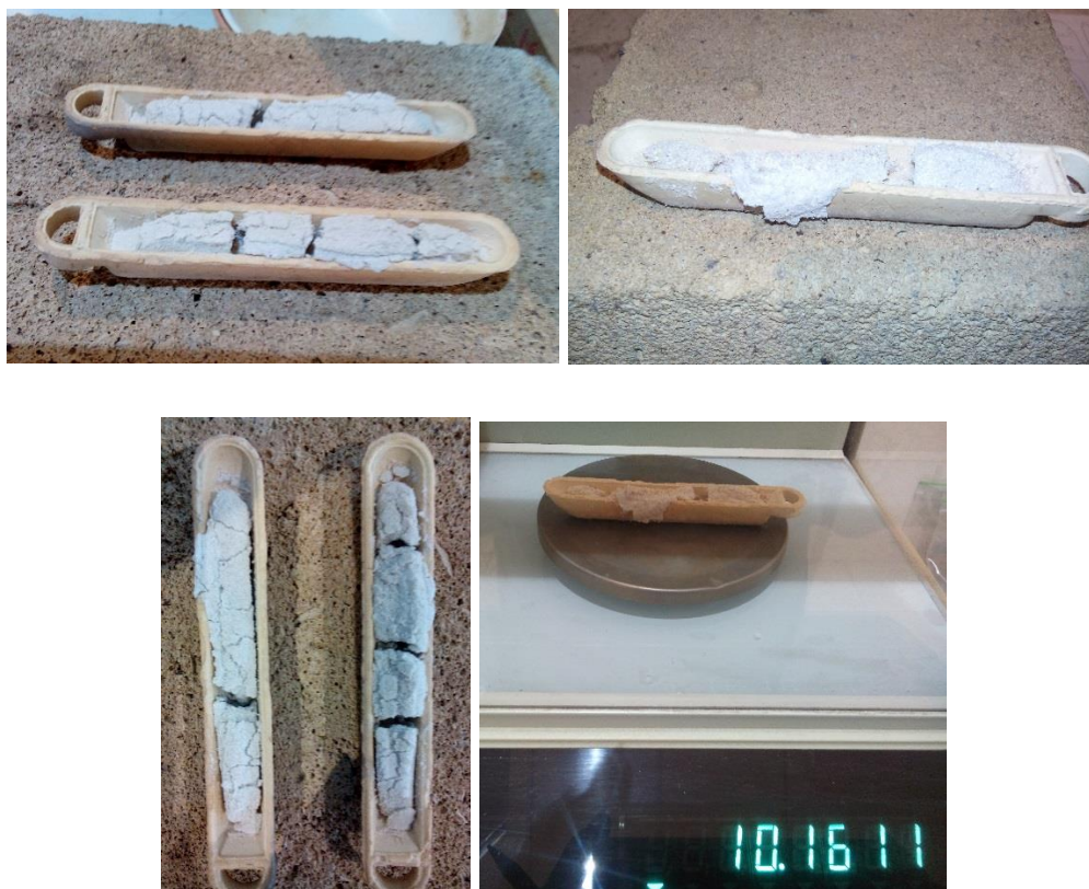
شکل ۴-۱۶: بوته‌های سنجش خاکستر بعد از کوره (کنسانتره آزمایش‌های شماره‌ی ۱۳ و ۱۴)
