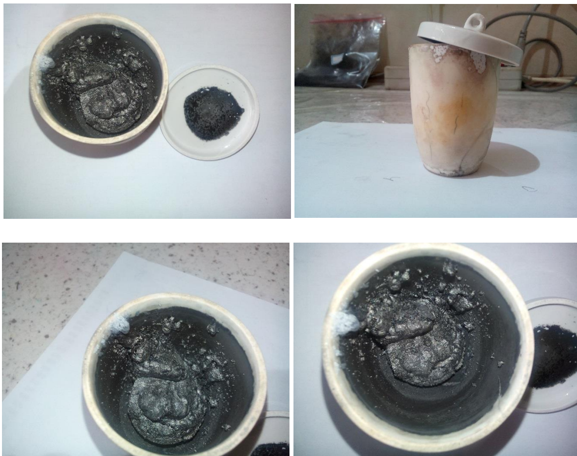
شکل ۴-۱۷: بوتله‌ی سنجش مواد فرار بعد از کوره (کنسانتره‌ی آزمایش شماره‌ی ۱۳)
