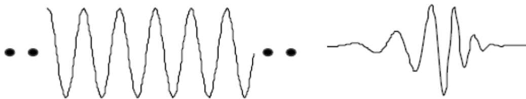
شکل ۳-۶. سمت چپ نمای یک موج (سینوسی) و سمت راست نمای یک موجک است (فوگال ۱ ، ۲۰۰۹).
