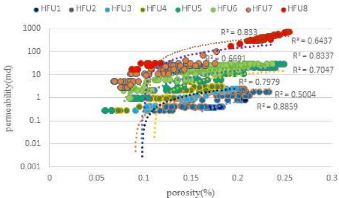
شکل ۳-۷۶- نمودار توزیع تخلخل- تراوایی برای هر یک از واحدهای جریانی مربوط به مخزن مورد مطالعه در چاه W- 2
