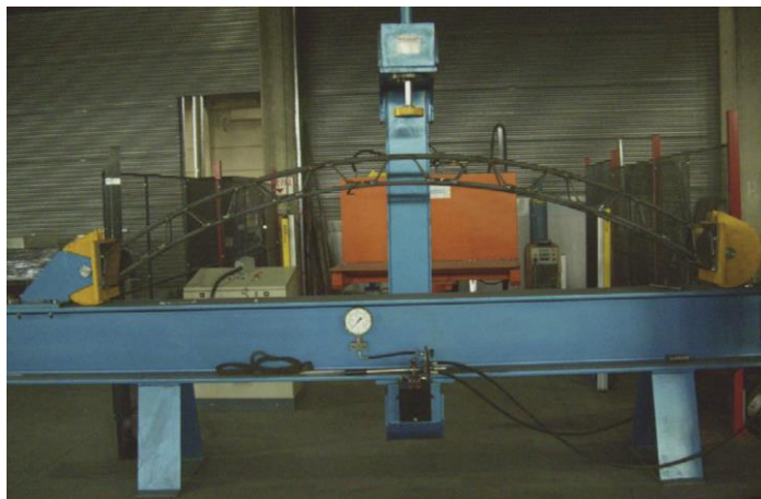
شکل ۲-۱۹: طرح آزمایشی برای آزمایش‌های بارگذاری قاب مشبک (Nomikos et al., 2013).
