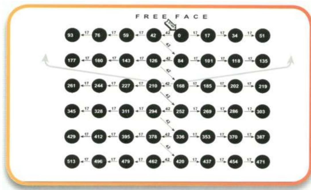
شکل (۱۵-۴) طراحی مدار انفجار و تأخیرها با استفاده از سیستم نانل [۲۰].
