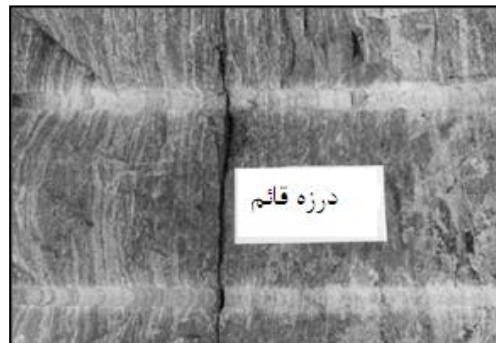
شکل ۲-۶- تأثیر درزه‌های محکم و بسته روی کیفیت دیواره تونل (Singh, 2001)
