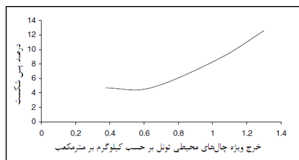
شکل ۲-۹- تأثیر فاکتور پودر چال‌های محیطی روی میزان پس‌شکست (Singh&Xavier, 2005)
