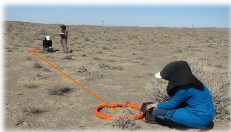
شکل ۳-۴: نمایش آرایش حلقه‌ها در برداشت داده‌های EM با دستگاه EM34-3.
