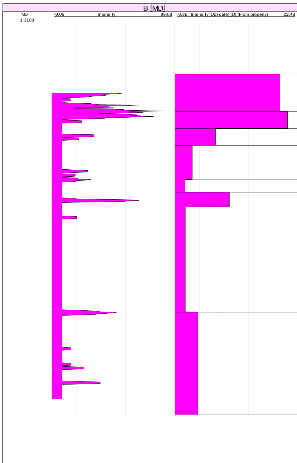
شکل ۴-۵ نمایش نمودار شدت شکستگی و نمودار شدت شکستگی بزرگ مقیاس شده چاه B
