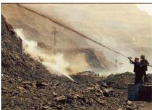
شکل ۳-۴: تزریق آب به دیوی باطله با روش تزریق مستقیم و اسپری آب (Chaiken & Bayles, 1988)
