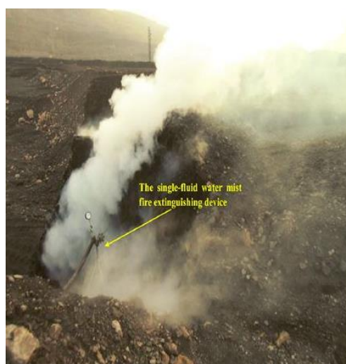
شکل ۷-۳: نمونه‌ای از سیستم مه‌پاشی برای مهار حریق (Ray & Singh, 2007).
