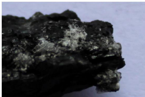
شکل ۴-۱۰: نمونه‌ای از کریستال‌های سولفات هیدرات حاصل از واکنش پیریت که در سطح زغال مشاهده می‌شود (Beamish et al., 2012)
