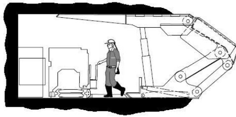
شکل ۴-۲۴: باقی گذاشتن زغال در سقف و کف کارگاه جبهه کار طولانی مکانیزه (عطائی، ۱۳۹۰)
