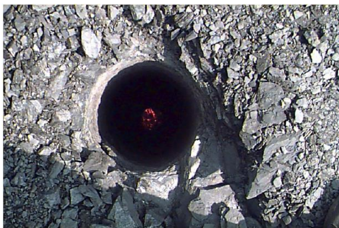
شکل ۳-۱۵: نمونه‌ای از گمانه پایش و اندازه‌گیری گرمایش خودبه‌خودی لایه زغال (Gangopadhyay, 2008)
