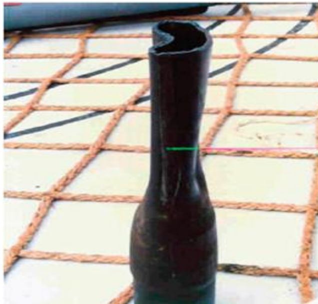
شکل ۲-۲: نمونه‌ای از گسیختگی لوله جداری در یکی از چاه‌های مکزیک (Asadi et al, 2011).
