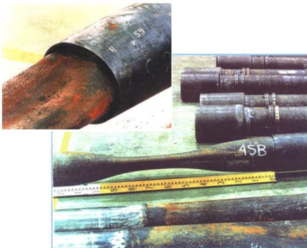
شکل ۲-۳: کمانش و مچالگی لوله جداری (Toscano, 2009).
