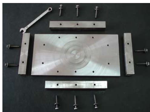
(ب) نحوه باز شدن وجه‌های قالب برای جدایش مناسب نمونه از قالب
