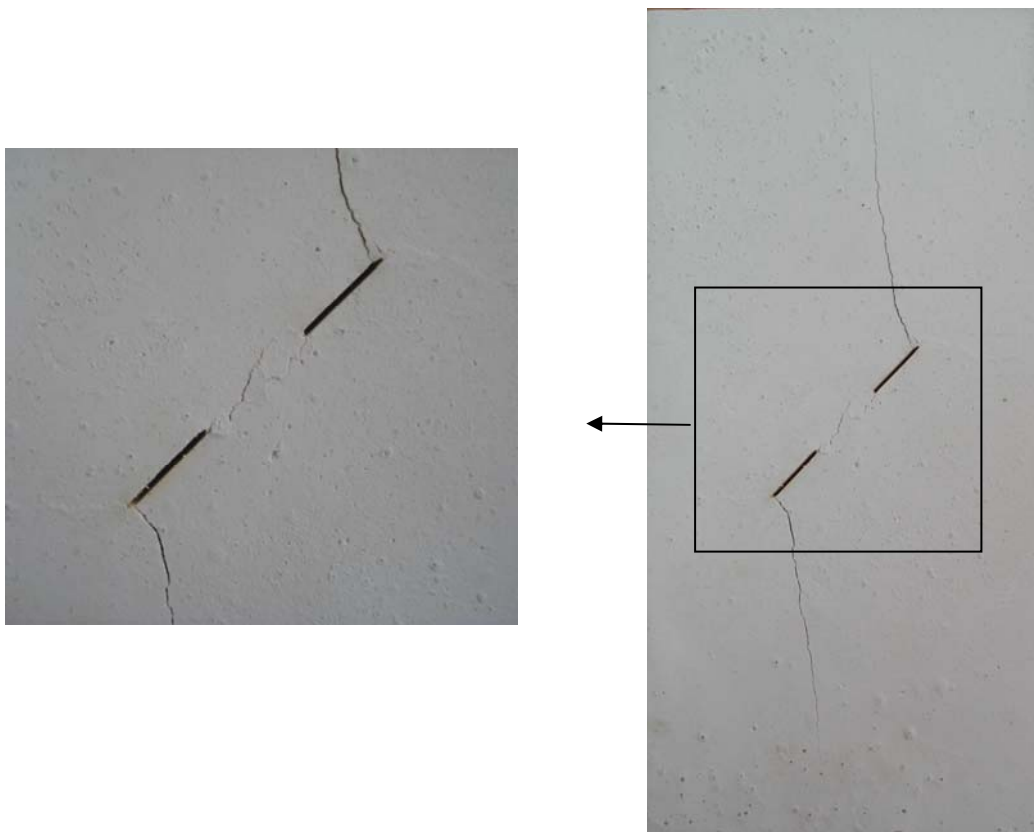
شکل (۴۴-۶): رشد ترک‌های کششی و برشی از نوک ترک‌ها در نمونه حاوی دو ترک شیب‌دار با شیب ۴۵ درجه، طول خط واصل ۲۰ میلی‌متر و شیب خط واصل ۴۵ درجه تحت بار فشاری تک محوری
