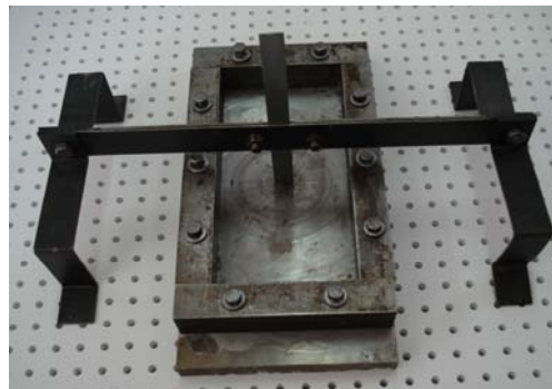
(الف) نحوه تنظیم صفحه فلزی در داخل قالب برای ایجاد ترک با شیب مشخص
