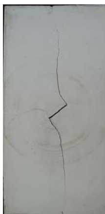
الف) مراحل مختلف رشد ترک و زاویه انتشار آن نسبت به خط قائم ب) شکل شماتیک پیش‌بینی عددی مسیر رشد ترک شبیدار ج) مسیر رشد ترک در یک نمونه گچی ترک‌دار با ابعاد 3 \times 10 \times 20 سانتی متر مکعب شکل (۵-۲۰): پیش‌بینی جهت رشد ترک در نمونه حاوی ترک شبیدار تحت بار فشاری
