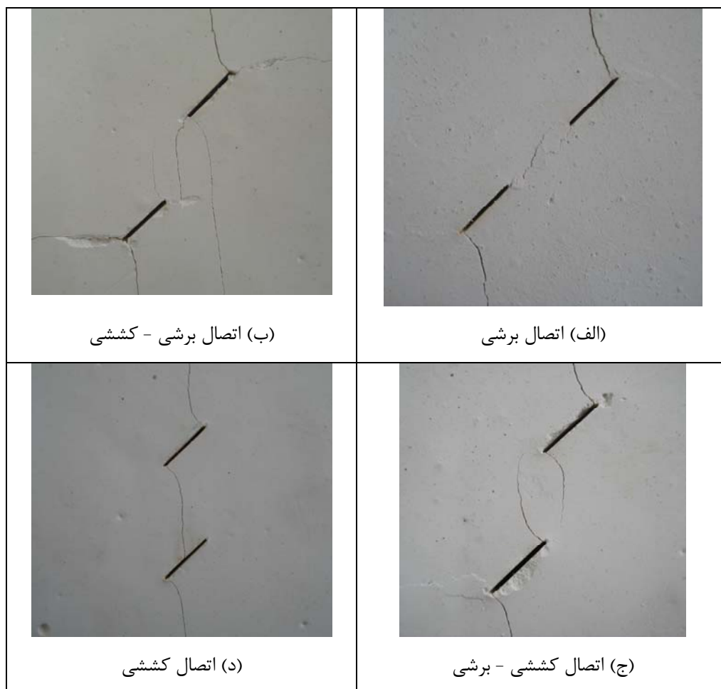
شکل (۶-۵۴): انواع اتصال ترک‌ها در مطالعات آزمایشگاهی رشد و اتصال ترک‌ها در نمونه‌های حاوی دو ترک
