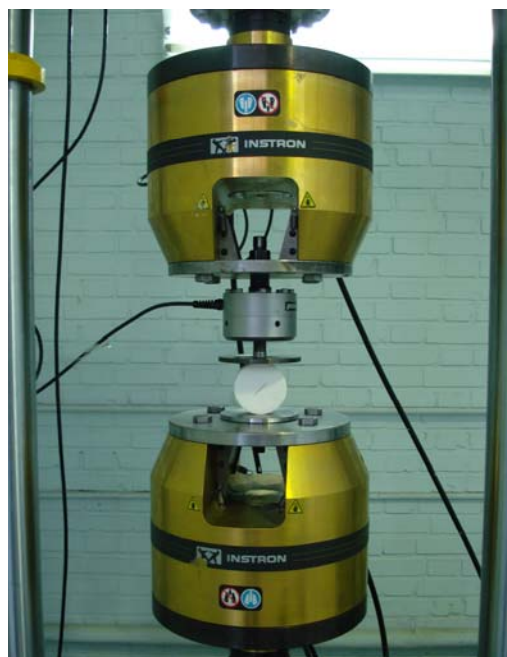
شکل (۶-۲۲): بارگذاری فشاری نمونه‌های دیسکی با دستگاه INSTRON و با سلول بار به ظرفیت ۲۵ کیلونیوتن
