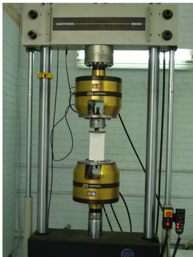
شکل (۶-۲۶): دستگاه بارگذاری INSTRON مورد استفاده برای بارگذاری نمونه‌های حاوی دو ترک
