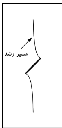
الف) مراحل مختلف رشد ترک و زاویه انتشار آن نسبت به خط قائم ب) شکل شماتیک پیش‌بینی عددی مسیر رشد ترک شبیدار ج) مسیر رشد ترک در یک نمونه گچی ترک‌دار با ابعاد 3 \times 10 \times 20 سانتی متر مکعب شکل (۵-۲۰): پیش‌بینی جهت رشد ترک در نمونه حاوی ترک شبیدار تحت بار فشاری
