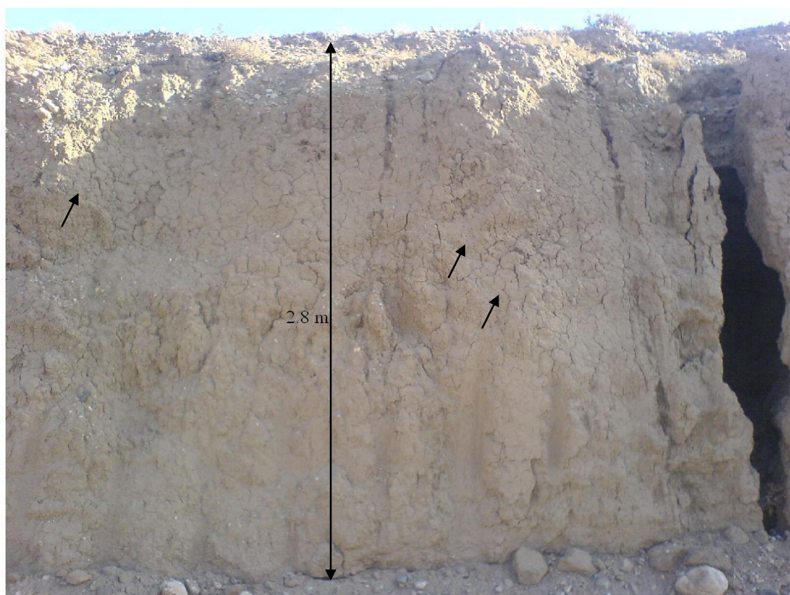
شکل ۴-۹: مقطع قائم از رسوبات سطحی منطقه برداشت، این مقطع دارای امتدادی عمود بر راستای پروفیل ۱ و به فاصله ۵ متر از ابتدای آن واقع است.
