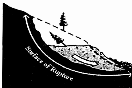
شکل الف-۱-۵: سطح گسیختگی
