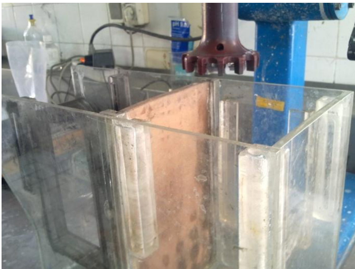
شکل ۴-۳- سلول فلوتاسیون الکتروشیمیایی اصلاح شده
