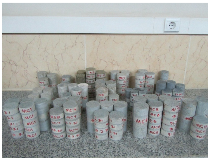
شکل ۵-۳: آماده‌سازی نمونه‌ها در آزمایشگاه مکانیک سنگ گل‌گهر
