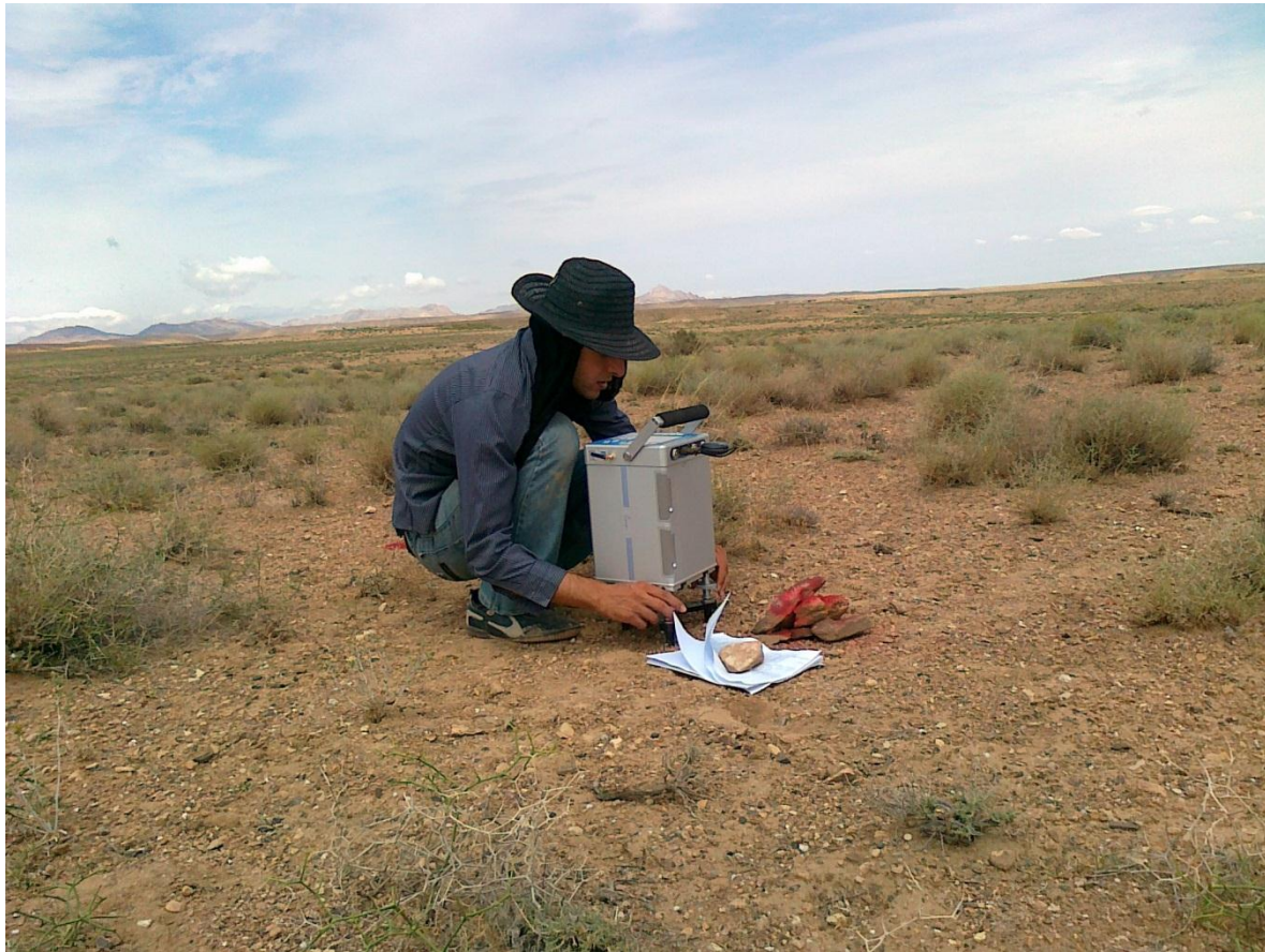
شکل (۵-۷): برداشت داده‌های گرانی منطقه مورد بررسی با دستگاه CG5
