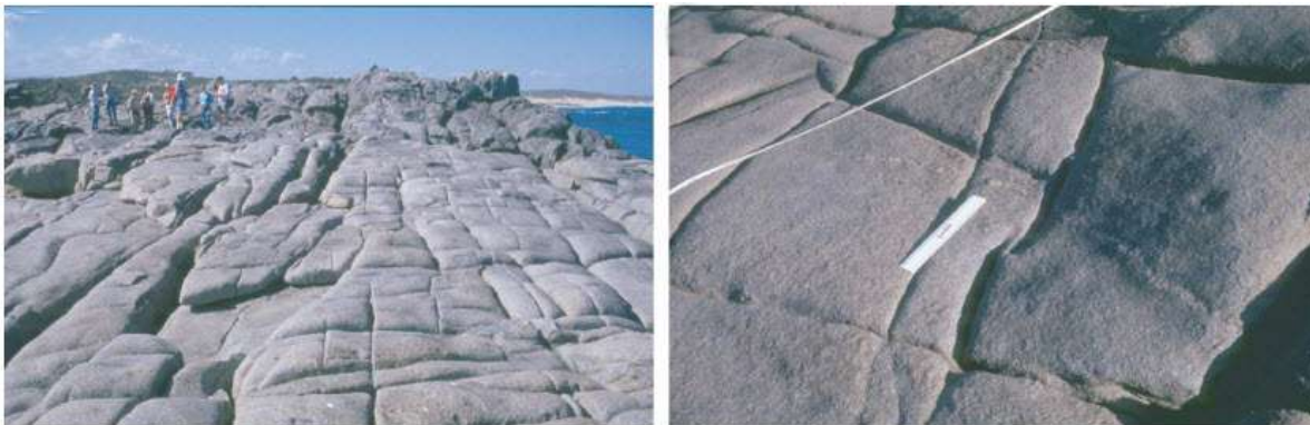
شکل ۲-۹: بلوک‌های نمایان در سطح زمین که به راحتی می‌توان حجم آن‌ها را محاسبه کرد [۵]
