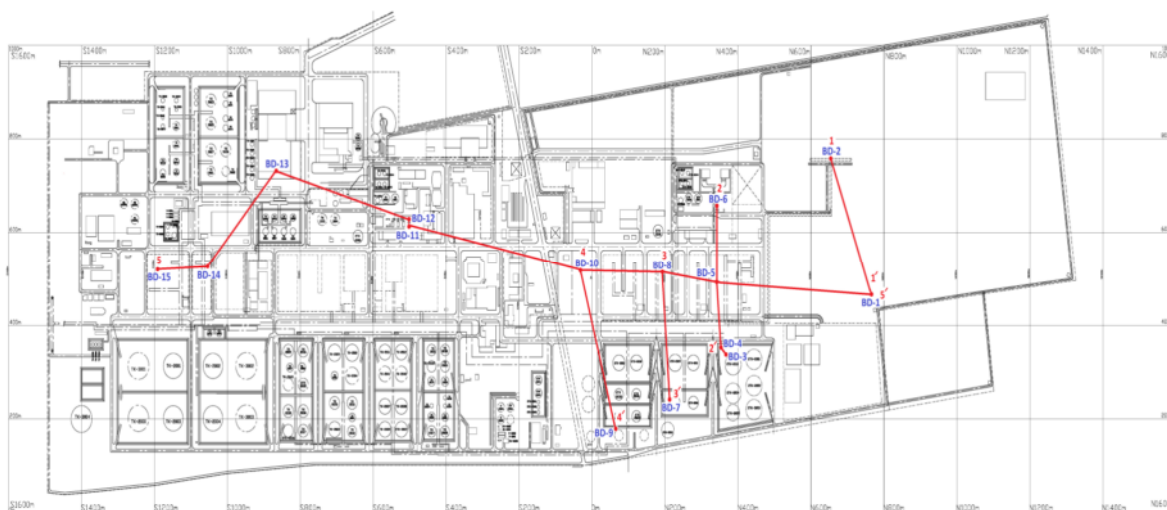
شکل (۵-۴): موقعیت پروفیل های خاک موجود برای بررسی در داخل سایت شرکت پالایش نفت تهران (Idemitsu engineering Ltd, 2003)
