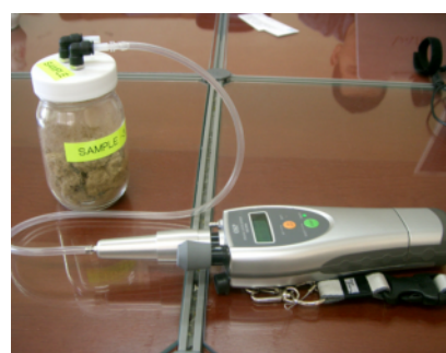
شکل (۵-۳۴): روش Headspace (Fusione Techno Solutions Co., 2006).
