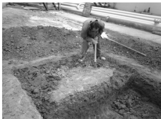
شکل (۵-۲۹): گمانه‌زنی آزمایشی به وسیله دست (Fusione Techno Solutions Co., 2006)
