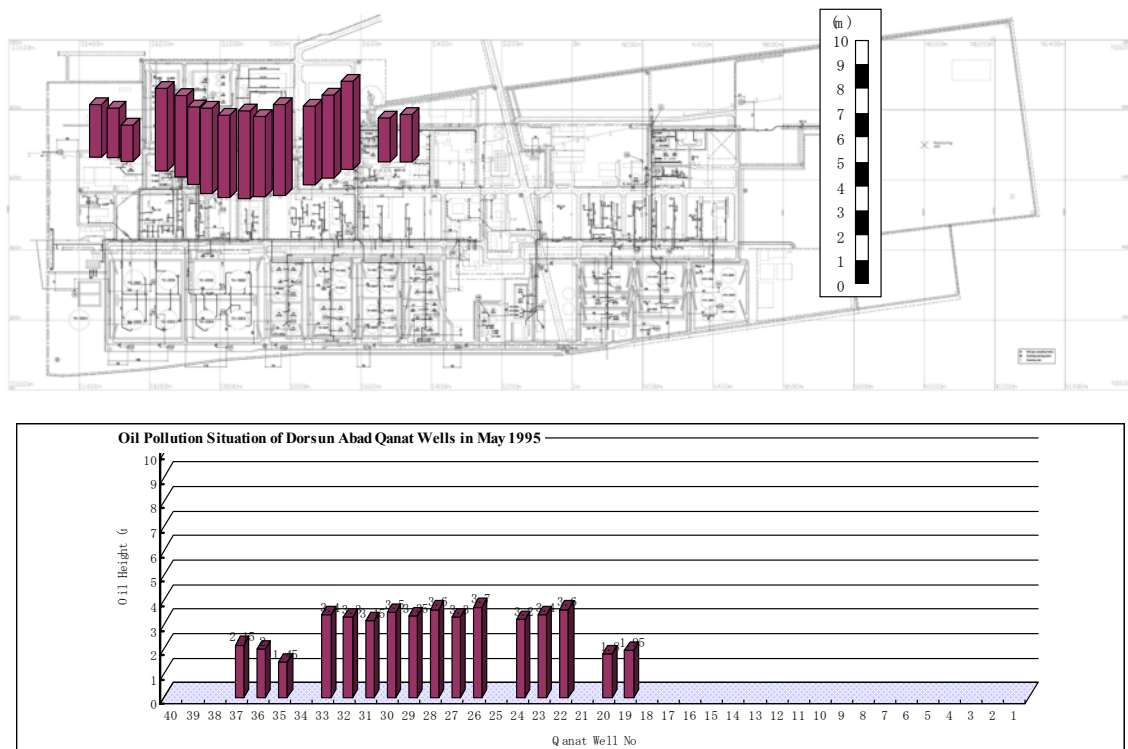
شکل (۵-۲۴): نتایج اندازه‌گیری عمق نفت در چاه‌های قنات در داخل سایت شرکت پالایش نفت تهران (اردیبهشت ۱۳۷۴) (Fusione Techno Solutions Co., 2006).
