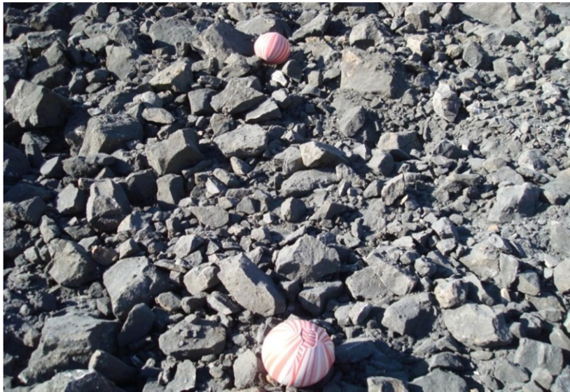
شکل ۵-۱۸: قرار دادن توپ به عنوان مقیاس بر روی قطعات خرد شده در زمان عکس‌برداری
