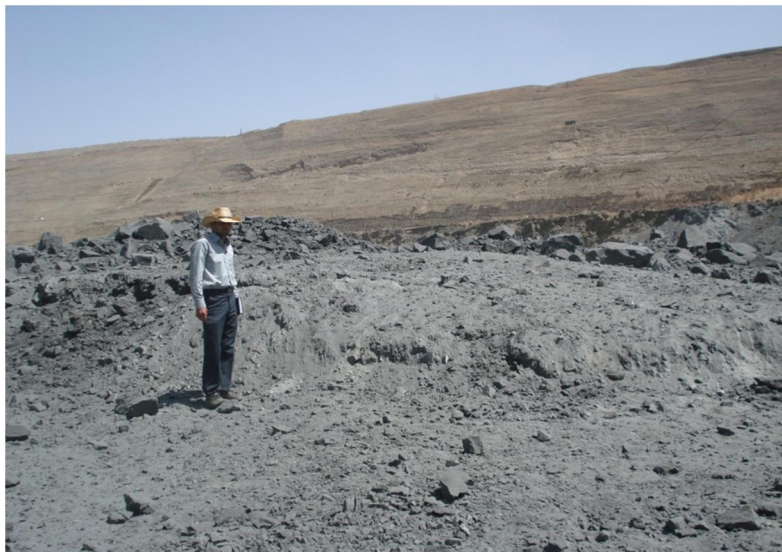
شکل ۵-۱۰: بالآمدگی سطح پله پس از انفجار ۱۷-۱۳
