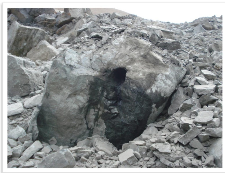
شکل ۵-۴: قسمتی از چال کاملاً سالم در قطعات درشت تولید شده (انفجار ۱-۸۹-۱۲)
