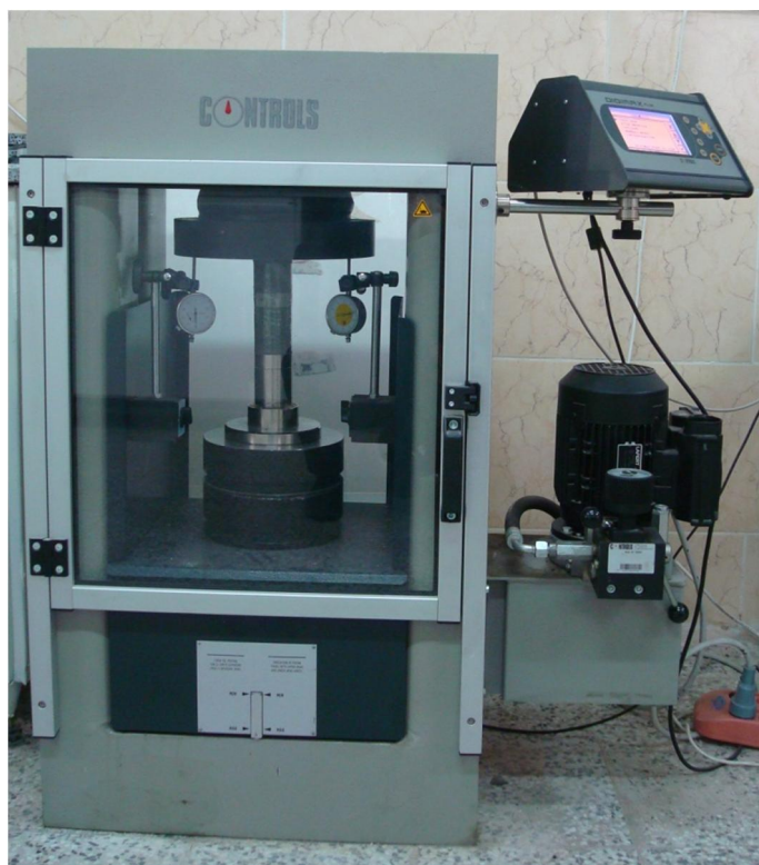
شکل ۵-۶: دستگاه مورد استفاده در آزمایش مقاومت فشاری تک محوری
