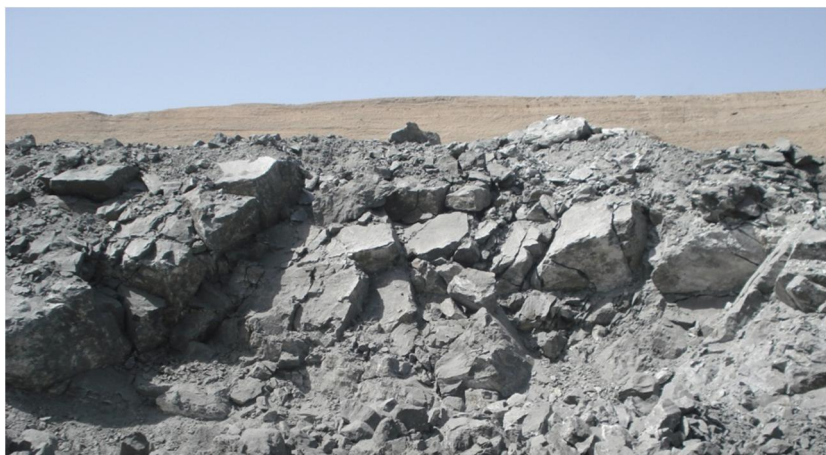
شکل ۵-۸: خردشدگی نامنظم در دیواره پله بعد از انفجار (انفجار ۱۵-۱۳)
