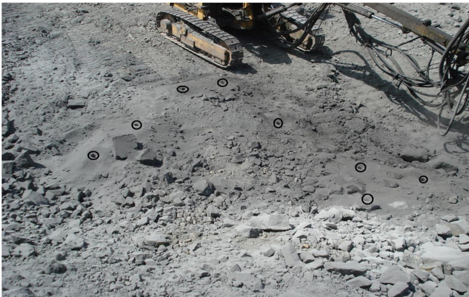
شکل ۵-۱۲: الگوی غیر منظم در حفر چال‌های پاشنه (انفجار ۹۱-۱۲)
