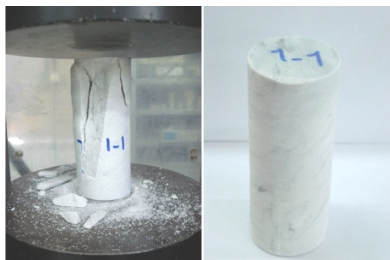
شکل ۲-۳: نمونه سنگ بادباد غربی قبل و بعد از آزمایش مقاومت فشاری
