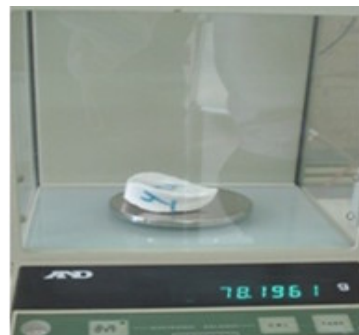
شکل ۳-۵: نمونه باد باد شرقی در حال اندازه‌گیری جرم خشک
